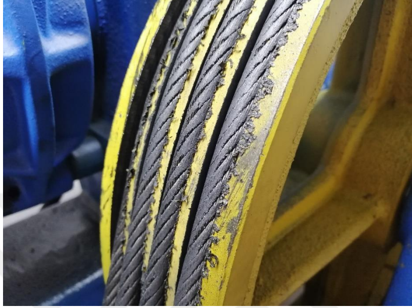
Resim 4.8 Aşınmış kasnak ve halat gerginlik ayarının olmaması
