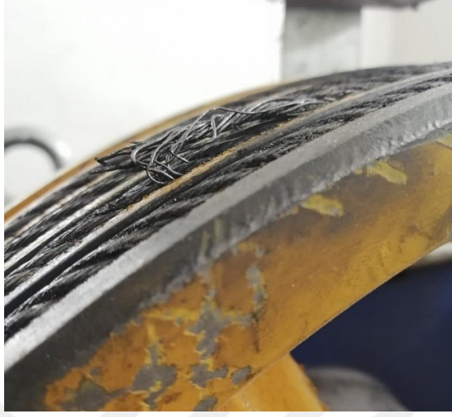
Resim 4.3 Deforme olan halat ve aşınmış kasnak
