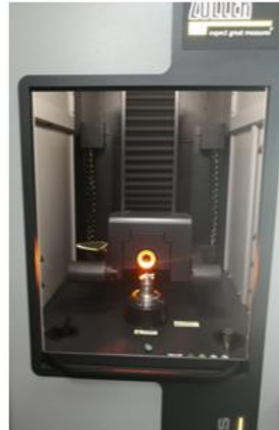
Şekil 3.3: Serbest yüzey aşınma görüntüleri ve Zoller Geius ölçüm cihazı.
