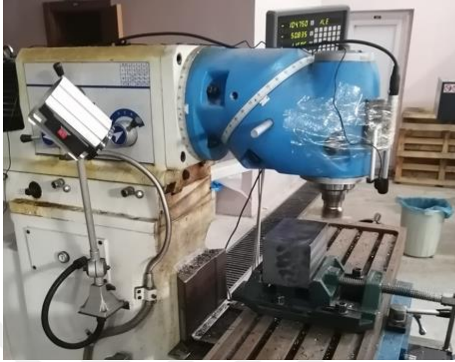
Şekil 3.5: Tezgâh başlığına sabitlenmiş mikrofonlar.
