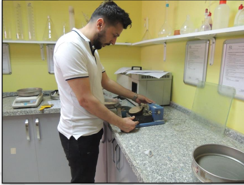
Şekil 4.10. Likit limit deneyi (cassagrande yöntemi)
