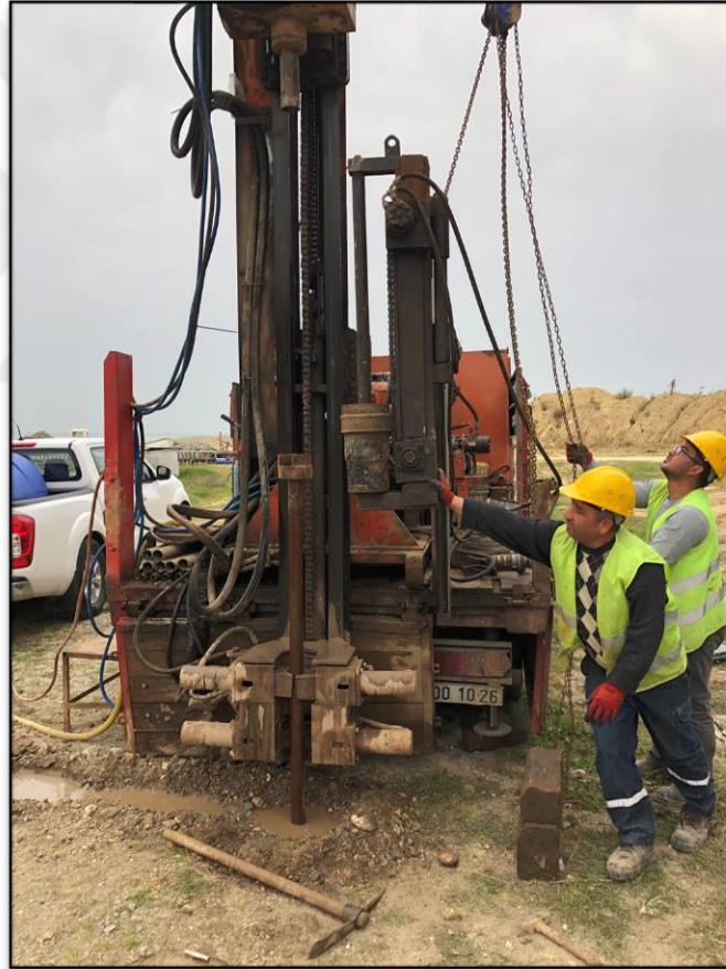
Şekil 4.5. SPT (Standart Penetrasyon Testi) deneyi
