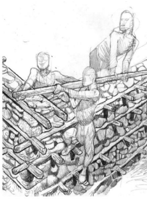
Şekil 2.23. Düğmeli evlerin inşa tekniğinden bir çizim görseli (Kavas, 2011)
