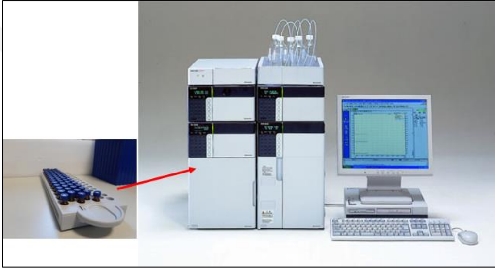
Şekil 3.9: HPLC sisteminde fraksiyonların ayarlanan metot ile ACE önleyici aktivite testinin çalışılması
