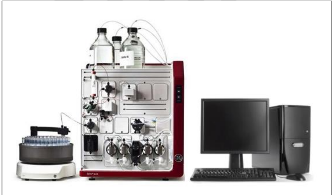
Şekil 3.8: FPLC sisteminde uygun metot ile fraksiyon toplayıcıda fraksiyonların falkon tüplere toplanması
