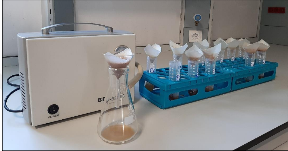
Şekil 3.17: Sindirilmiş ürünlerin kaba filtreden geçirilmesi
