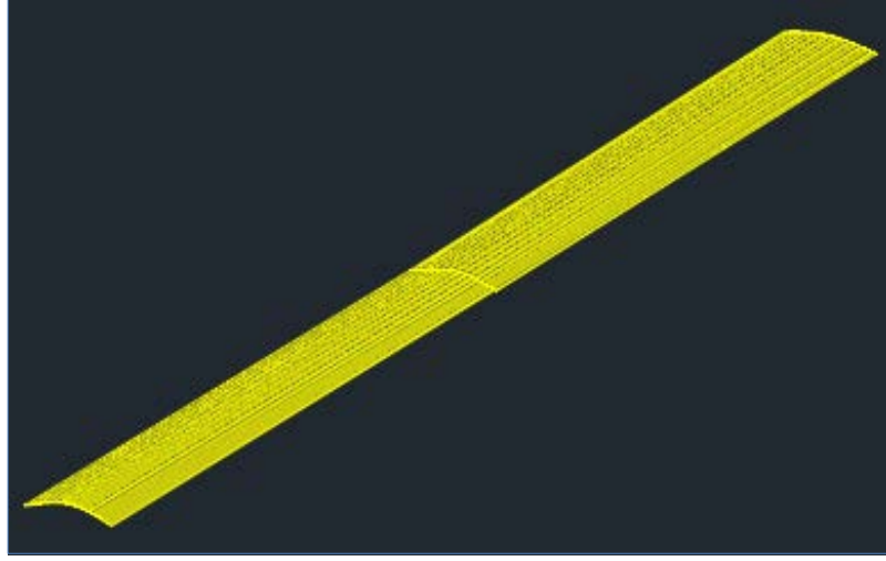
Şekil 3.21 Hazır tip kauçuk hız tümsek-3 (3 Boyutlu Profili).
