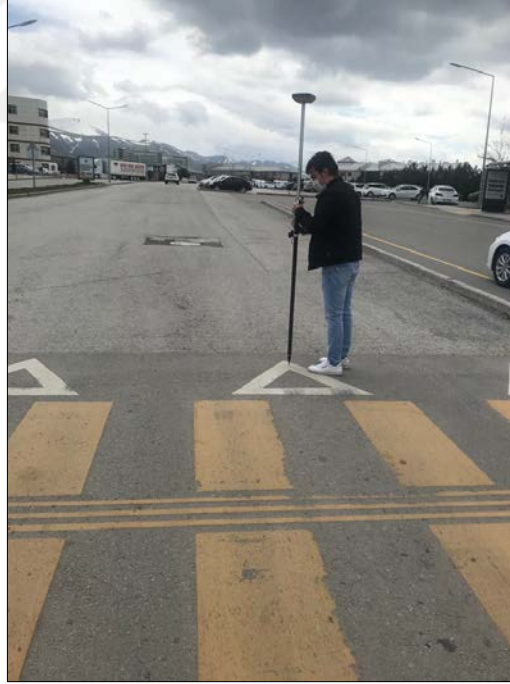
Şekil 3.12 Arazide CORS cihazı ile ölçüm yapılması.
