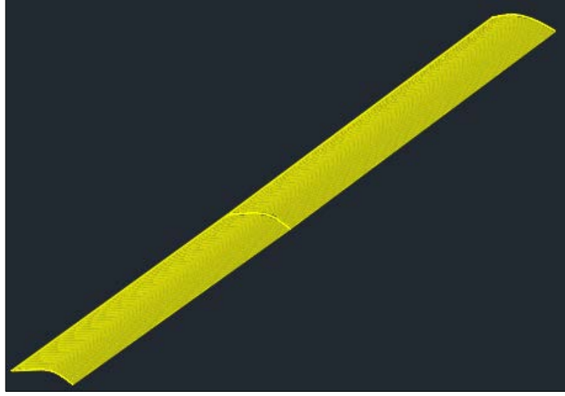
Şekil 3.19 Hazır tip kauçuk hız tümsek-1 (3 Boyutlu Profili).
