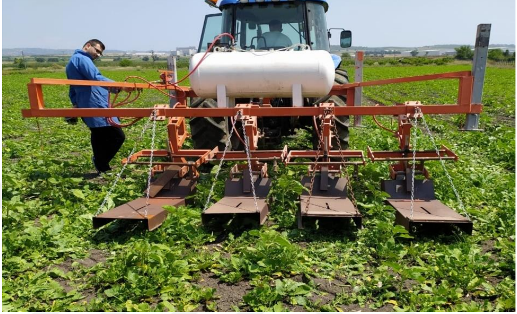
Şekil 3.2. Üç metre iş genişliğine sahip sıra arası alevleme makinesi
