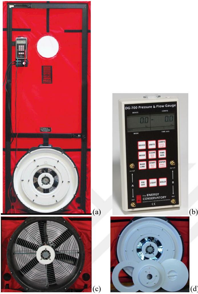
Şekil 3.10. Fan basınçlandırma test ekipmanı: (a) Minneapolis Blower Door Model 3, (b) basınç ölçüm ağı, (c) fan, (d) hava akış halkaları (TEC, 2020)
