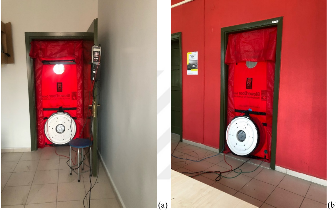
Şekil 3.11. 203 no’lu hacme kurulan Minneapolis Blower Door 3 test düzeneği (a) basınçsızlaştırma testi – fan/cihaz içeride, (b) basınçlandırma testi – fan/cihaz dışarıda
