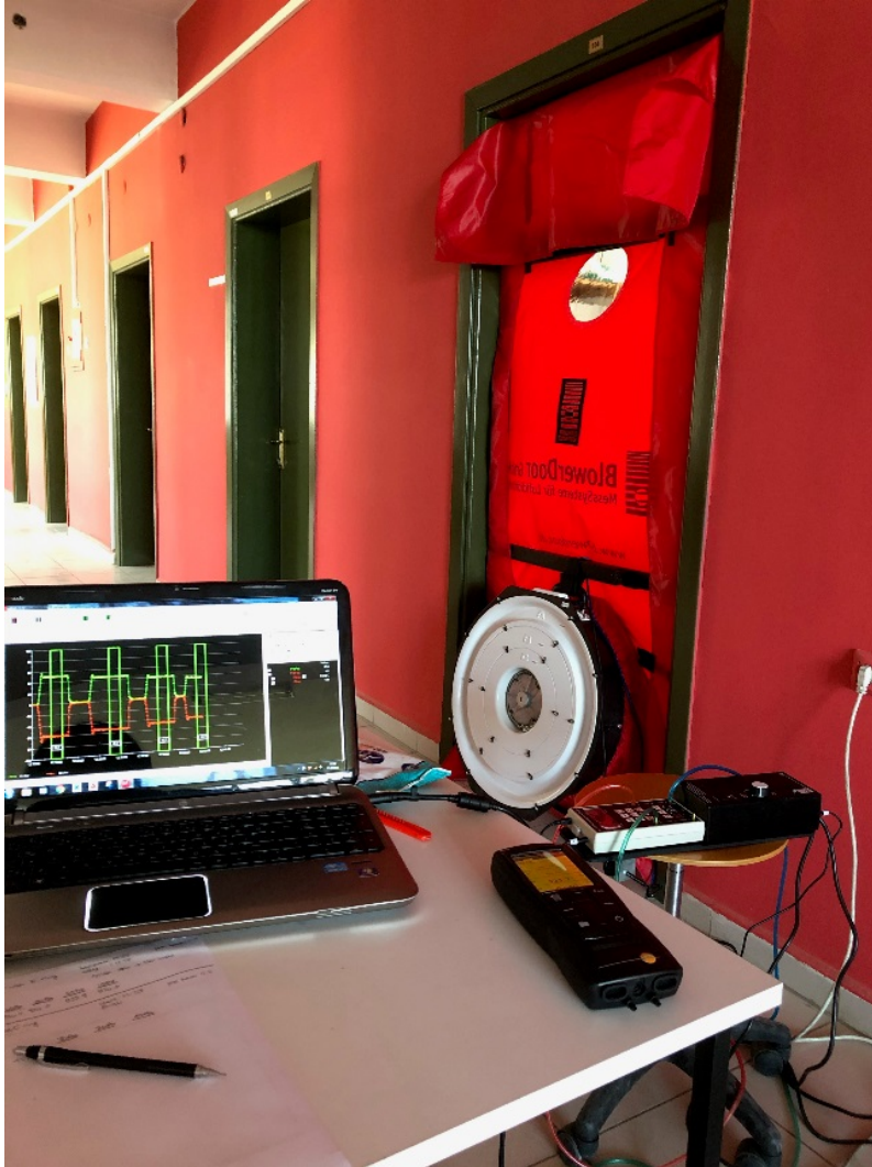
Şekil 3.17. Kesinleşmiş ölçüm protokolü, örnek basınçlandırma ölçümü
