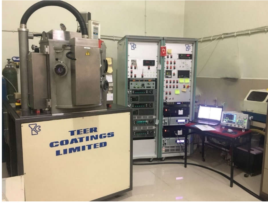
Şekil 25. Teer Coatings, PVD sistemi
