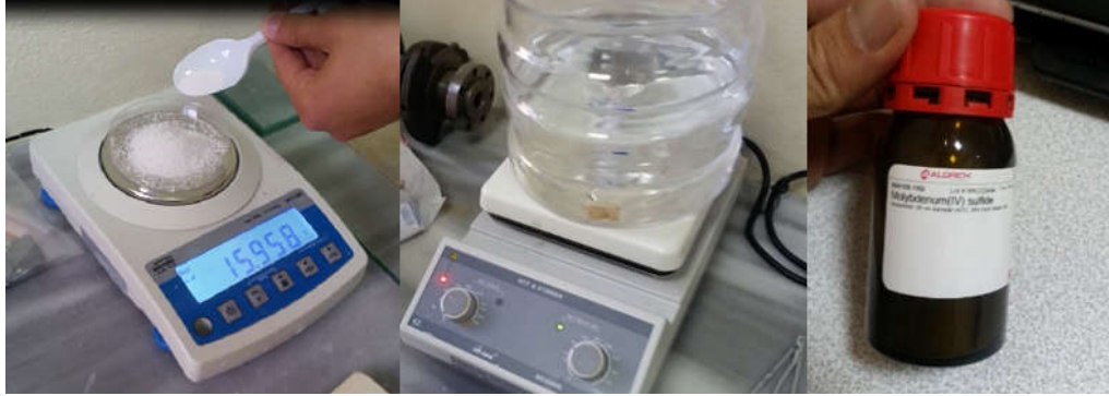
Şekil 24. PEO işleminde kullanılan elektrolitlerin hazırlanması.
