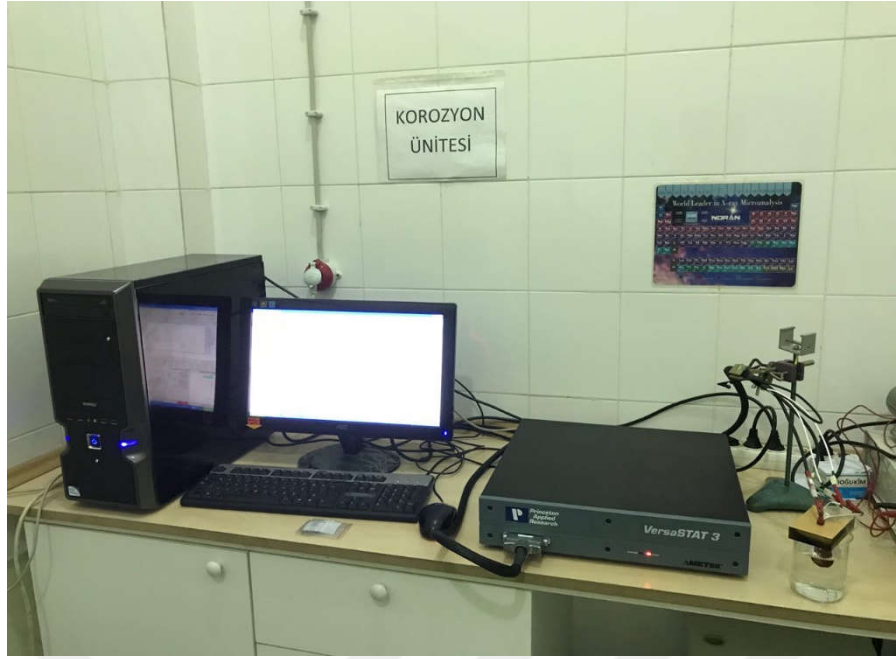
Şekil 31. Korozyon Deney Düzenekinin Şematik Gösterimi
