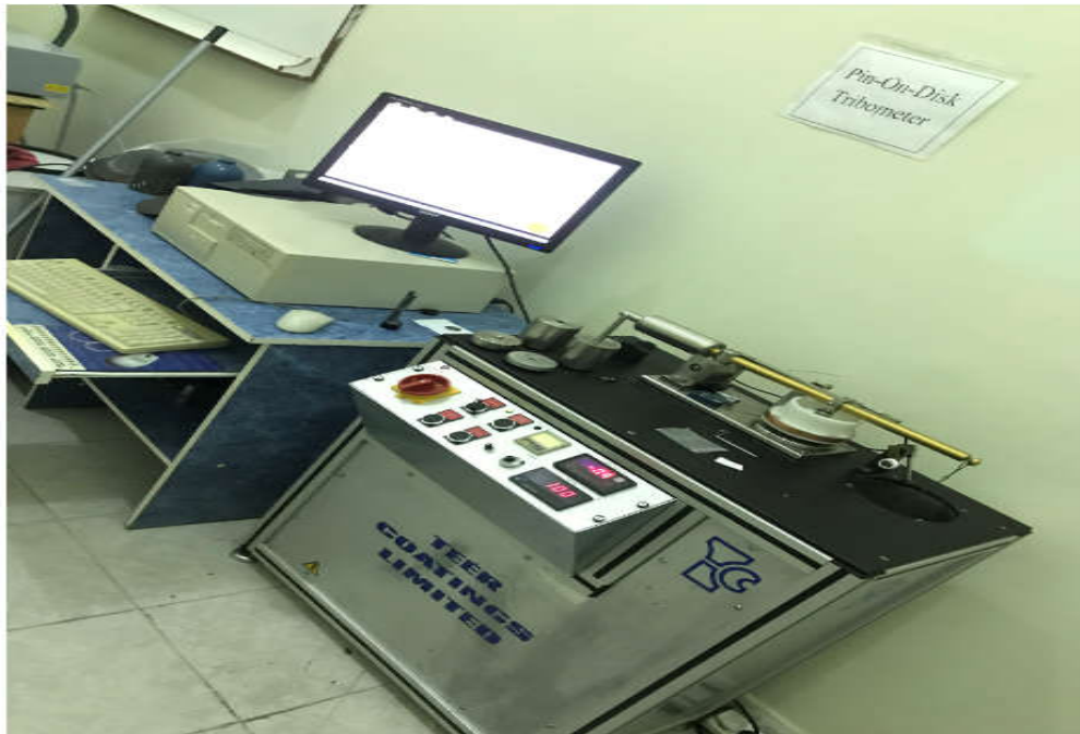
Şekil 30. Aşınma deneylerinde kullanılan pin-on-disk aşınma test cihazı
