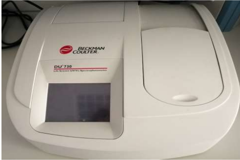
Şekil 3.4. E.coli 'nin optik dansitesinin belirlendiği spektrofotometre cihazı
