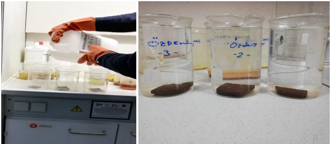
Şekil 2.7: Asitle muamele deneyi
