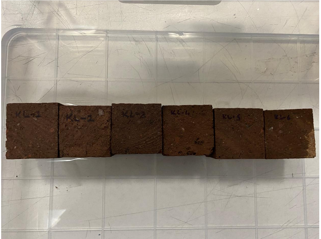
Şekil 4.8: Kılcal etkiye bağlı su emme için suda bekletilen numuneler
