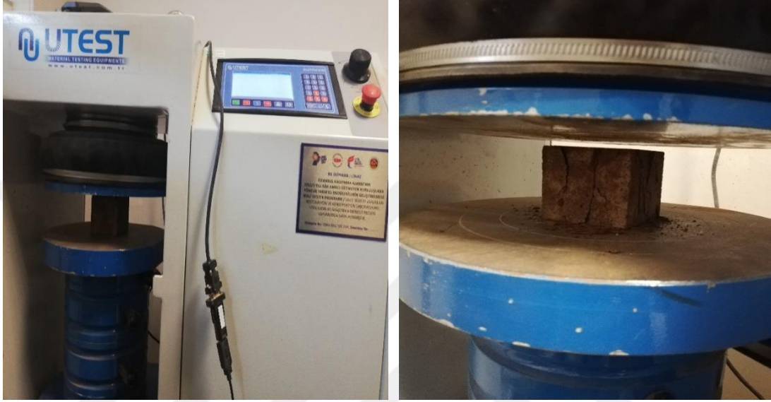
Şekil 2.22: Tek eksenli basınç deneyi cihazı ve deney sonrası numune
