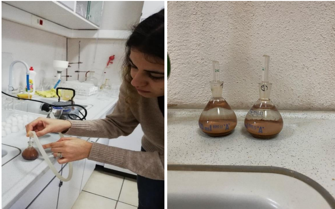
Şekil 2.19: Piknometrenin vakum motoru ile havasının alınması ve numuneler
