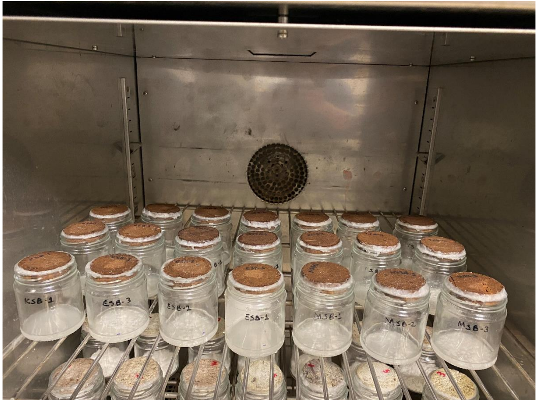
Şekil 4.18: Deney sonucunda sıvı hale gelen CaCl_2
