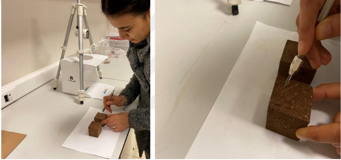
Şekil 2.21: Ahlat taşının Mohs sertliđinin belirlenmesi
