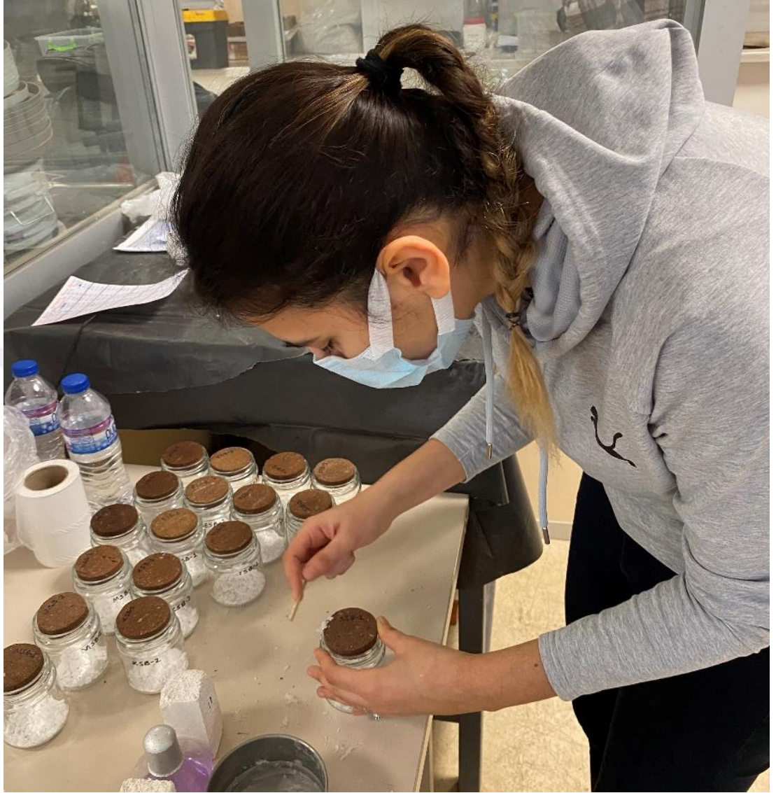
Şekil 4.16: Su buharı geçirgenliği deneyi için numunelerinin hazırlanması
