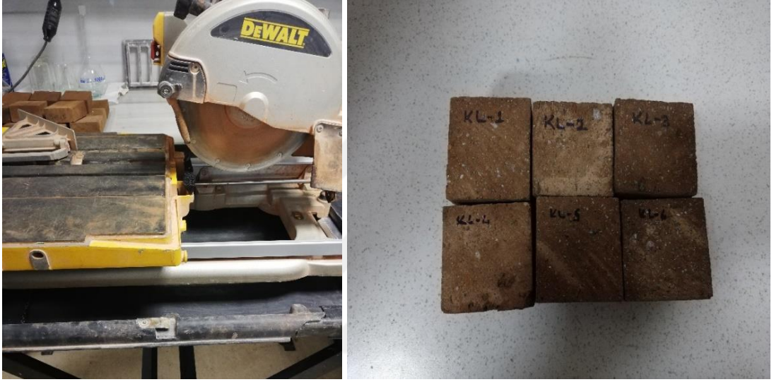
Şekil 2.18: Numunelerin boyutlandırılması ve hazırlanan küp numuneler
