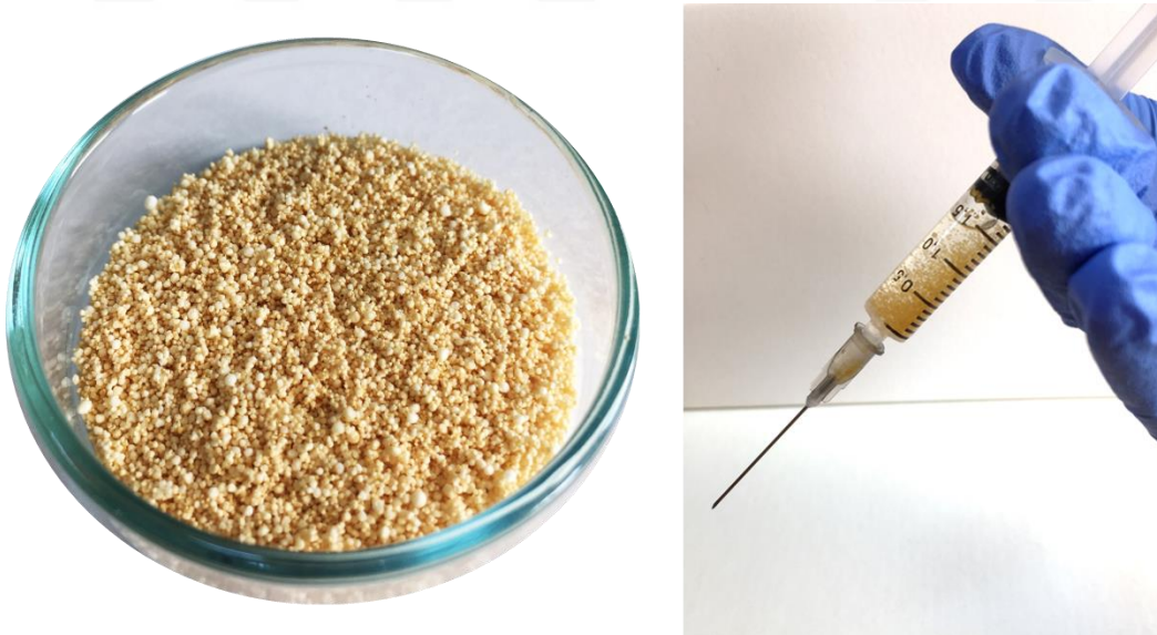
Şekil 4. 2. Üretilen mikrokürelerin petri kabı içerisindeki kuru formda ve enjektör içinde süspansiyon haldeki görüntüsü
