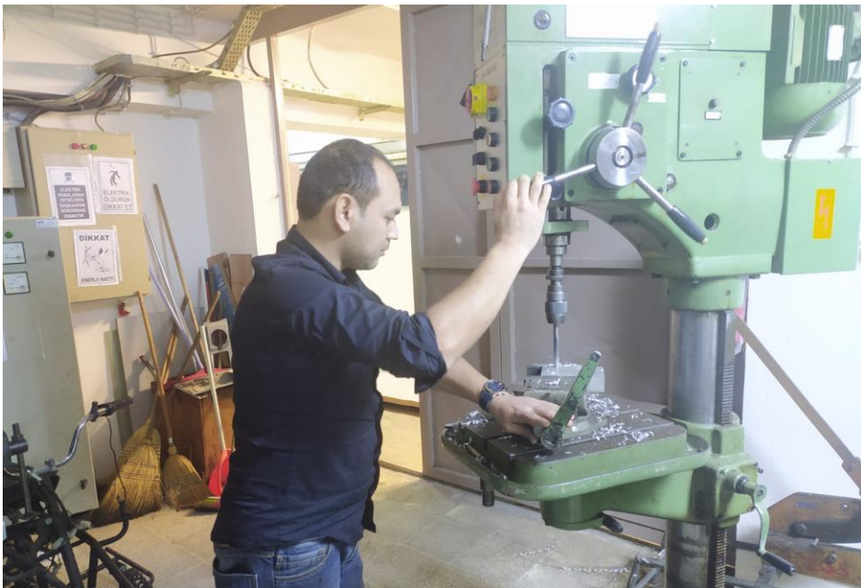
Ek-4. Deney D zeneg nde Kullanılan Par aların Delmesi ve Punt-Laması İ in Tezsan Matkap Tezg h  Kullanıldı.
