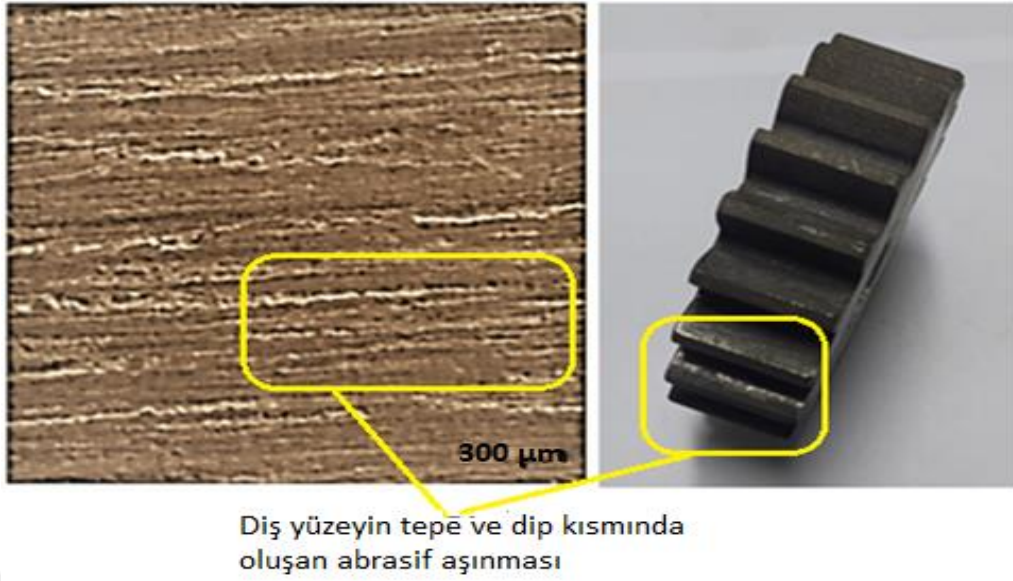
Şekil 3.12. Deney Çalışmada 500000 Dönme Tekrarından Sonra WS 2 Kaplamalı Düz Dişli Yüzeyi Mikroskop Görüntüsü.
