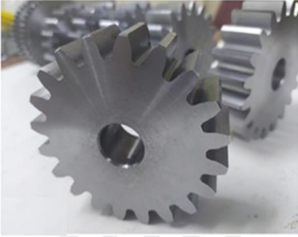
Şekil 2.3 Paslanmaz Çelikten İmal Edilmiş Düz Dişli Çark Görüntüsü.
