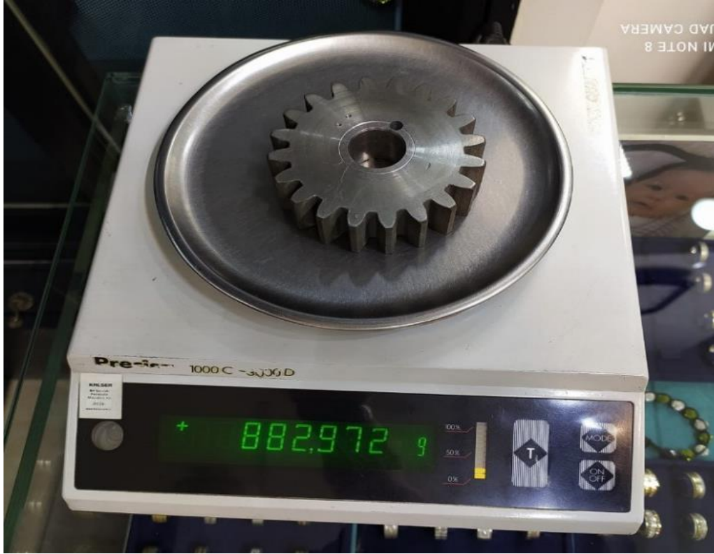
Şekil 2.20. Binde Bir Hassasiyeti Sahip Terazide Numunelerin Ağırlığı Ölçümü.
