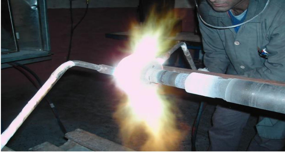
Şekil 2.8. Prokap Makine Firmasında Numunelerin WS_2 , WC/C ve MoS_2 Termal Püskürtme Yöntemi ile Yüzey Kaplaması Uygulaması.
