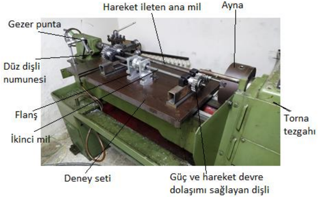
Şekil 2.23. Montajı Yapılan FZG Deney Seti ve Uygulama Çalışması Tezgâhı, Smarc LC360B Universal Torna Tezgâhı.
