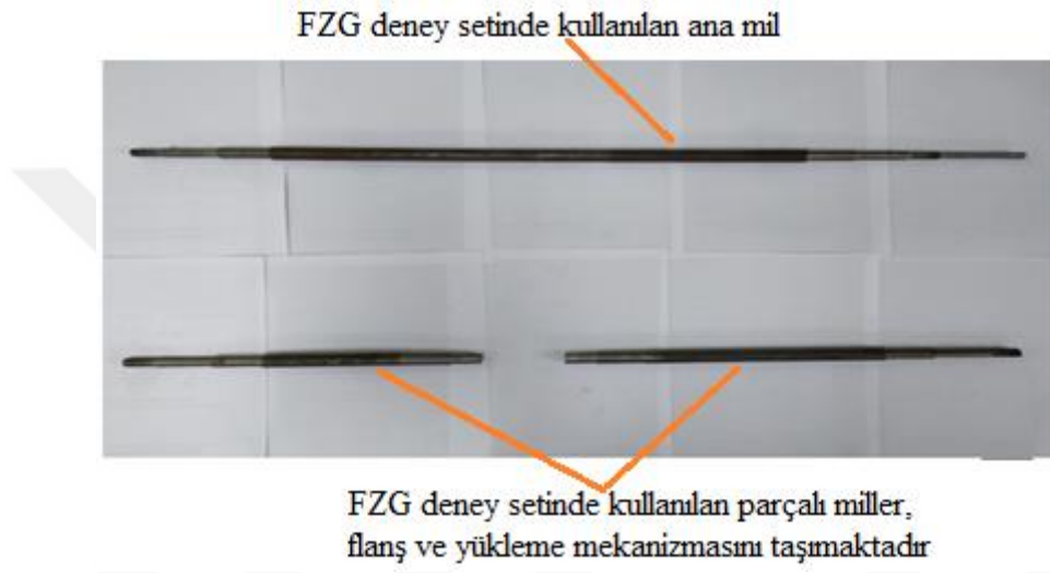
Şekil 2.14. FZG Deney Setinde Hareket ve Gücü Dişlileri Dağıtan Miller.
