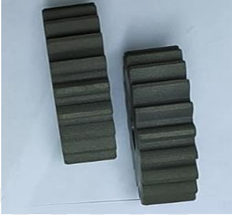
Şekil 2.11. WS 2 Kaplamalı Düz Dişli Numunenin Diş Yüzeyin Görüntüsü.
