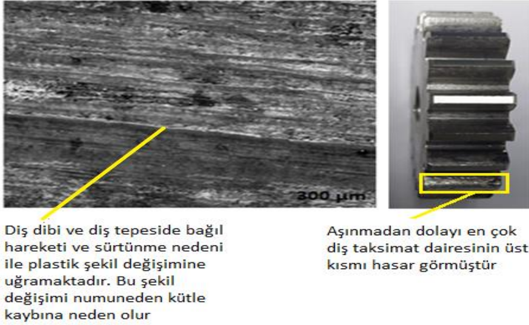
Şekil 3.11. Deney Çalışmada 500000 Dönme Tekrarından Sonra Kaplamasız Düz Dişli Yüzeyi Mikroskop Görüntüsü.
