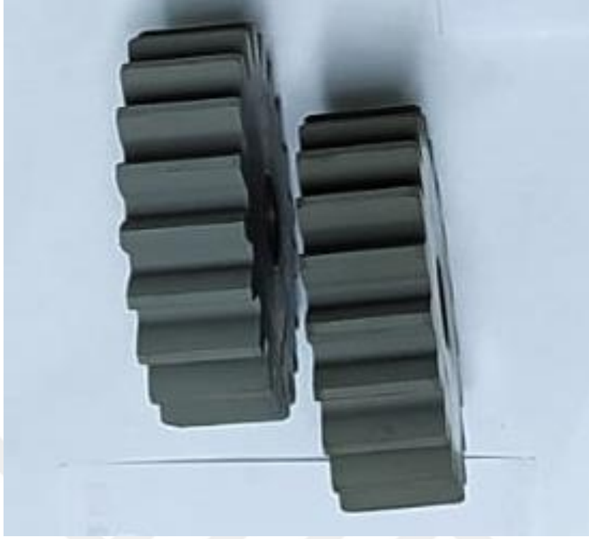
Şekil 2.12. WC/C Kaplamalı Düz Dişli Numunenin Diş Yüzeyin Görüntüsü.
