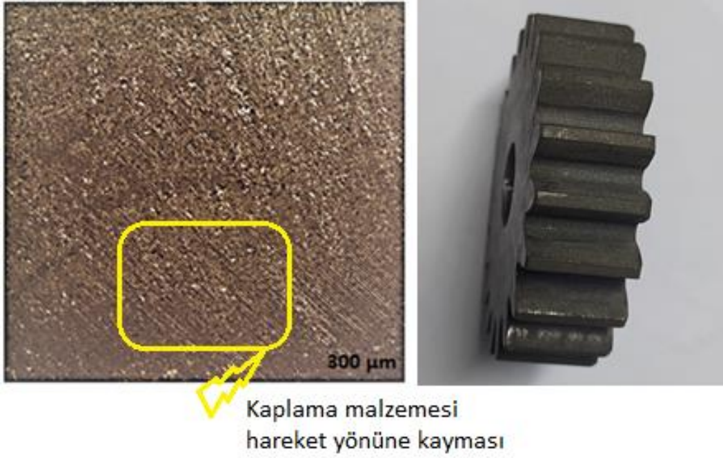
Şekil 3.8. Deneysel Uygulama 250000 Dönme Tekrarından Sonra WS_2 Kaplamalı Düz Dişli Yüzey Mikroskop Görüntüsü.
