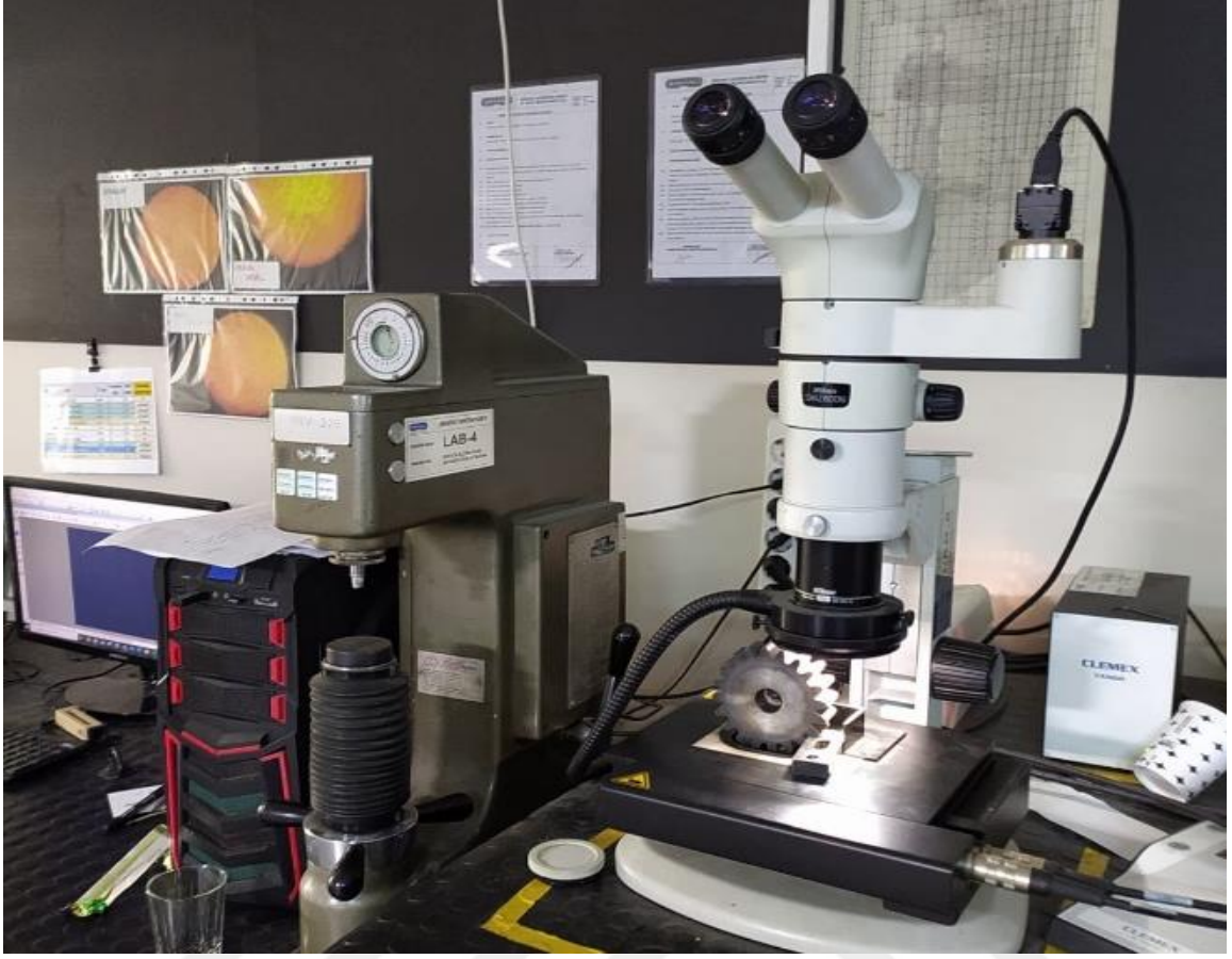
Şekil 2.22. Düz Dişli Numunenin Diş Yüzeyin Muayenesi Nikon Smz800n Stereo Mikroskop Cihazı ile Ölçüldü.
