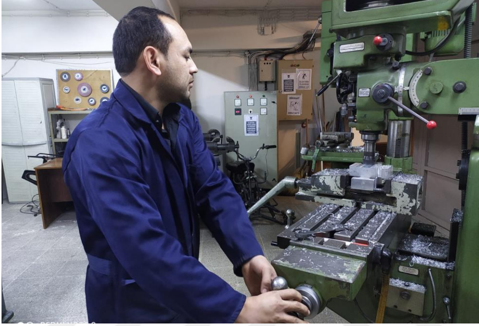
Ek-3. FZG Deney Düzeneg n Par aları Evrensan Freze Tezgahında Frezeledi.
