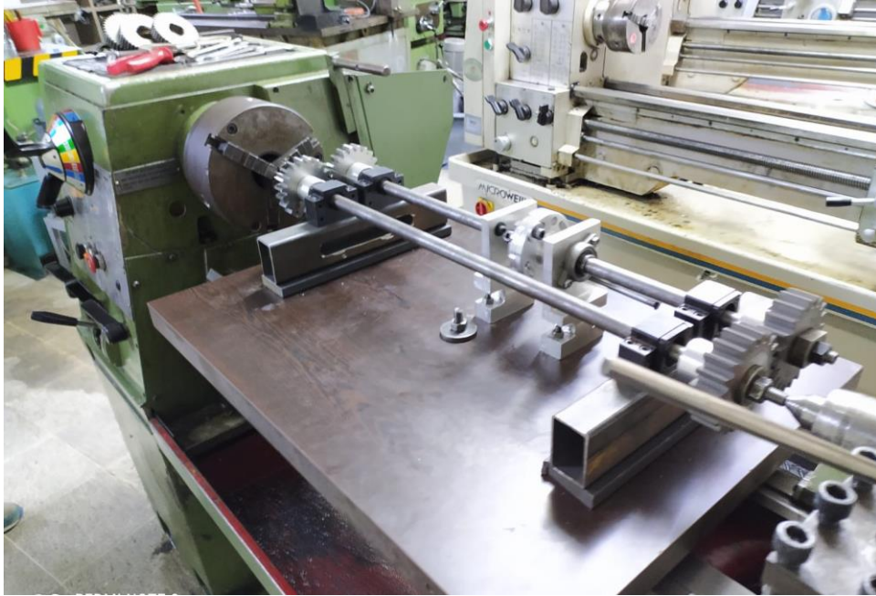
Ek-6. Güç Devre Dolaşımı Deney Seti Smarc LC360B Universal Torna Tezgahında Montaj Yapıldı
