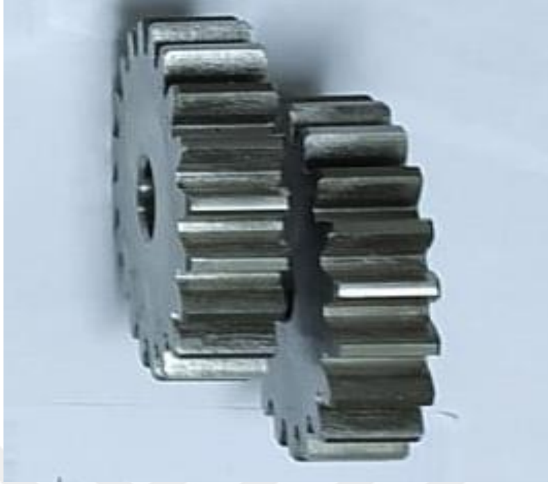
Şekil 2.10. Kaplama Yapılmamış Düz Dişlinin Dış Yüzeyin Görüntüsü.
