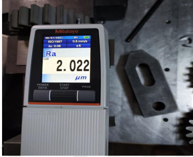
Şekil 2.21. Düz Dişli Numunenin Diş Yüzeyin Pürüzlülük Değeri Mitutoyo Pürüzlülük Cihazı ile Ölçüldü.
