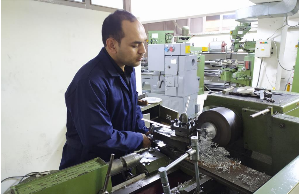
Ek-2. Deney Setin Paçaları Smarc LC360B Universal Torna Makinesinde İmal Edildi
