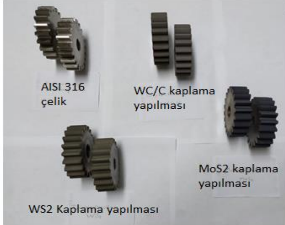
Şekil 2.9. Prokap Makine Firmasında 316 Paslanmaz Çelikten Numunelerin WS_2 , WC/C ve MoS_2 Termal Püskürtme Yöntemi ile Yüzey Kaplamaları Yapılmıştır.
