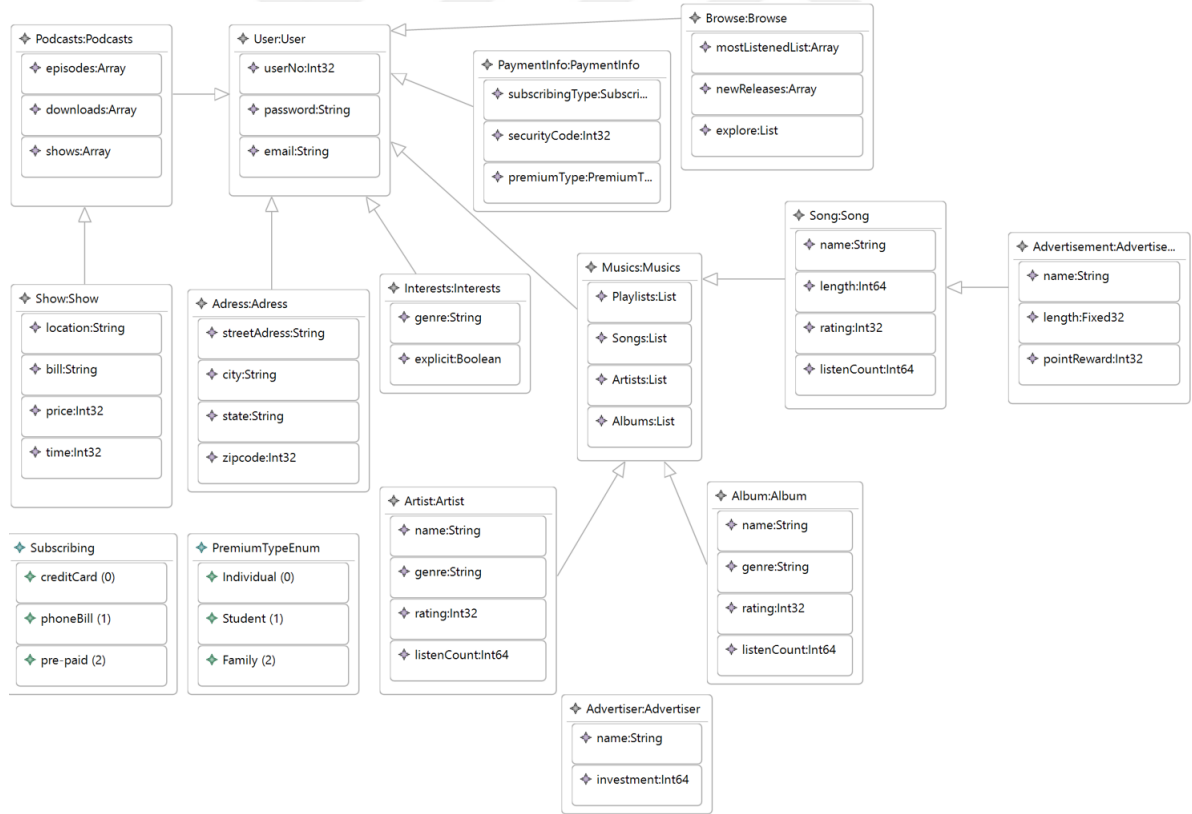
Şekil 8.11. Spotify müzik uygulaması için tasarlanan Mikroservis Veri Değişim Modeli
