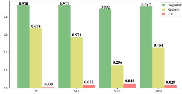
Şekil 5.5: Önerilen yöntem, SIFT, SURF, DAISY karma atakların karşılaştırılması
