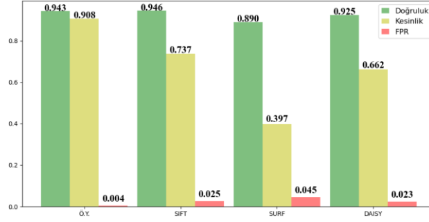
Şekil 5.4: Önerilen yöntem, SIFT, SURF, DAISY çarpıtma atağı karşılaştırılması
