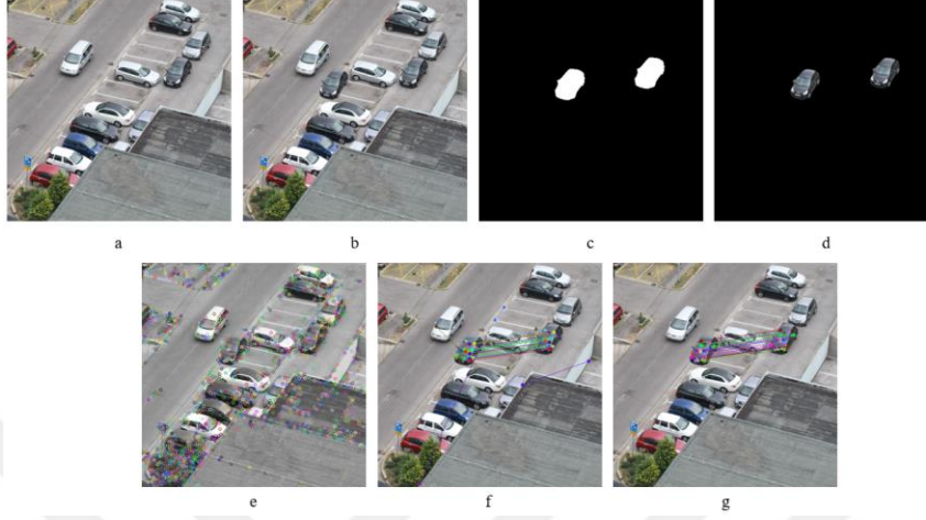
Şekil 4.4: COMOFOOD-26 Sonuçları a) Orijinal görüntü b) Bozulmuş görüntü c) Bozulmuş görüntü ikili maskesi d) Bozulmuş görüntü renkli maske e) SIFT köşe noktaları f) Önerilen yöntem eşleme sonrası g) RANSAC sonrası
