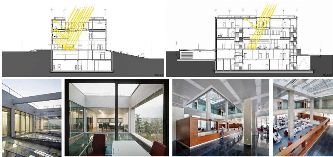
Şekil 4.12. Bursa Merkez Binası çatı ışıklığı (Anonim 2012)
