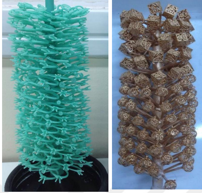
Resim 2.57: Mum kalıpların ağaca dizilerek döküme hazırlanması ve dökümden çıkan döküm ağacı.
