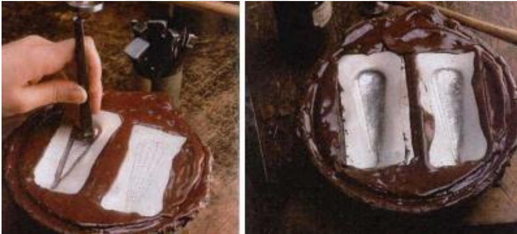
Resim 2.55: Zift kaplı yüzeyin ısıtılarak zemine yapıştırılan madene Repousse işleminin uygulanma aşaması.
