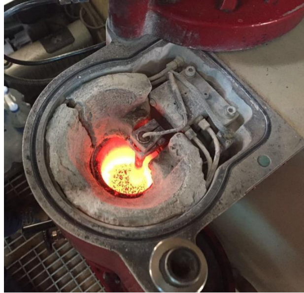
Resim 2.58: Dökülecek olan değerli madenin döküm makinasında eritilme işlemi.
