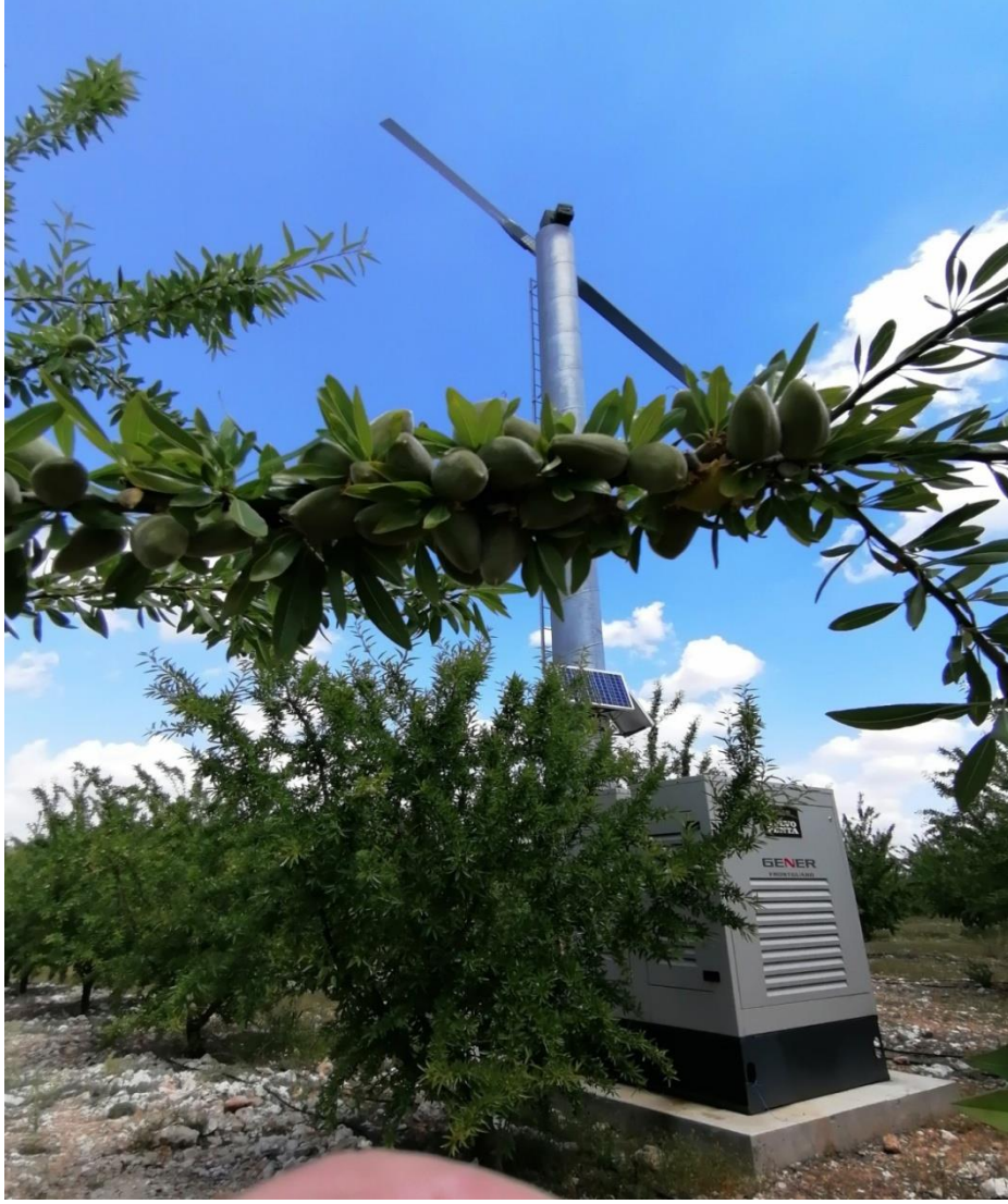
Resim 3.9. Denemede kullanılan zirai don pervanesi
