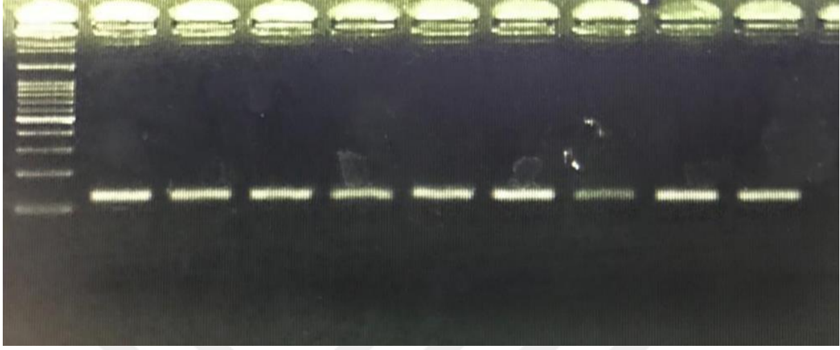
Şekil 4.3 rs187238 polimorfizminin % 1,5'lik agaroz jel elektroforezi PCR ürünleri kontrolü. İlk kuyucukta 100 bp DNA Ladder diğer kuyucuklarda ise farklı bireylere ait PCR ürünleri bulunmaktadır.
