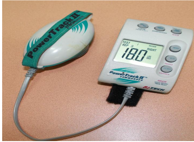
Şekil 3: Powertrack II El Dinamometresi
