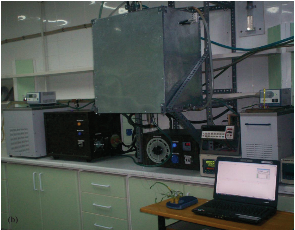
Şekil 2.14. Radyal ısı akış sisteminin (a) Blok diyagramı (b) Fotoğrafi.
