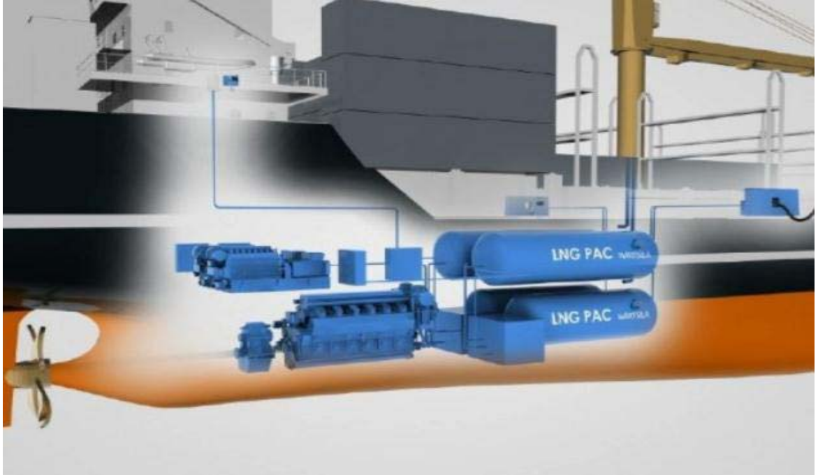
Şekil 16: LNG Yakıtlı Geminin Makine Yerleşim Düzeni
