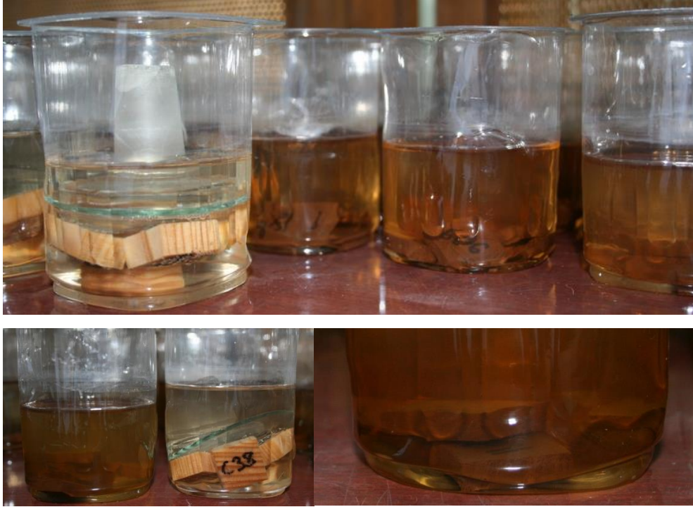
Şekil 3.10: Suda bekletilen odun-PP kompozit örnekleri.
