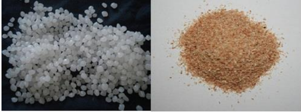
Şekil 3.1: Odun-PE kompoziti üretiminde kullanılan polietilen granülleri ve odun unu.
