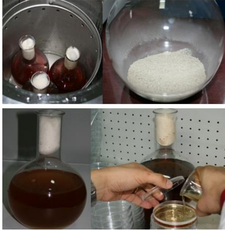
Şekil 3.7: Malt agar besi ortamının hazırlanması.
