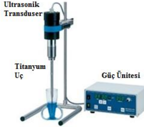
Şekil 3.1. CNT 'nin epoksi içerisinde dağıtılmasını sağlayan sonikatör
