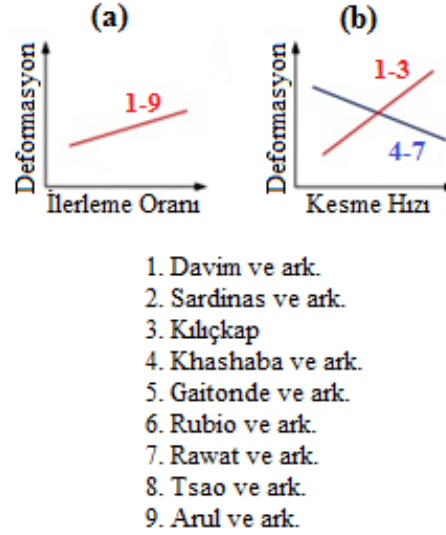
Şekil 4.6. Literatürde ilerlemenin ve kesme hızının deformasyona etkisi (Liu ve ark., 2012)
