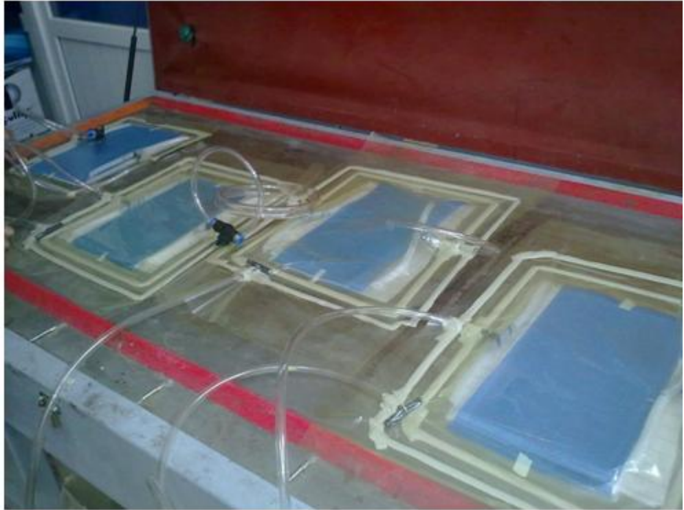
Şekil 3.4. Katkılı ve katkısız kompozit malzeme üretim şekli
