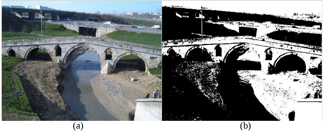
Şekil 4.18 : (a) Orijinal görüntü (b) Otsu eşik metoduna göre 0.4863 sınır eşik değeri sonucunda oluşan görüntü.
