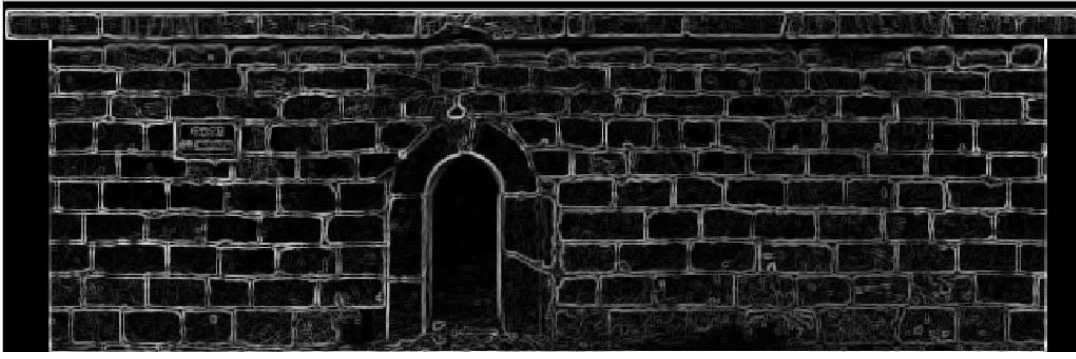
Şekil 4.29 : Prewitt gradientinin G_x + G_y yönünde oluşan görüntü.
