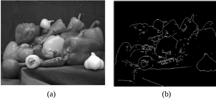
Şekil 2.28 : (a) Orijinal görüntü (b) Sobel kenar belirleme yöntemi ile oluşan görüntü.
