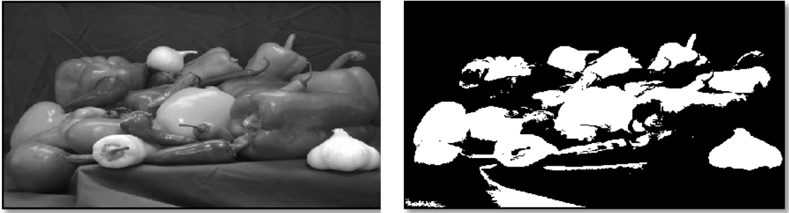
Şekil 2.17 : Otsu eşik değeri algoritmasıyla elde edilen görüntü.
