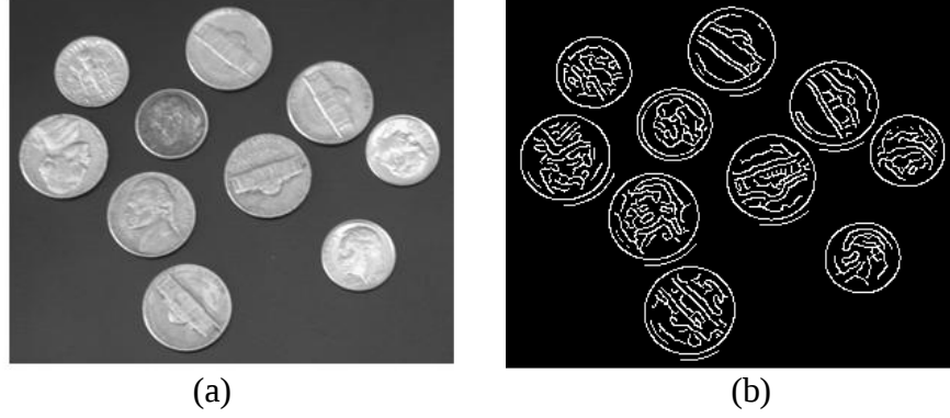
Şekil 2.29 : (a) Orijinal görüntü (b) Canny kenar belirleme yöntemi ile oluşan görüntü.
