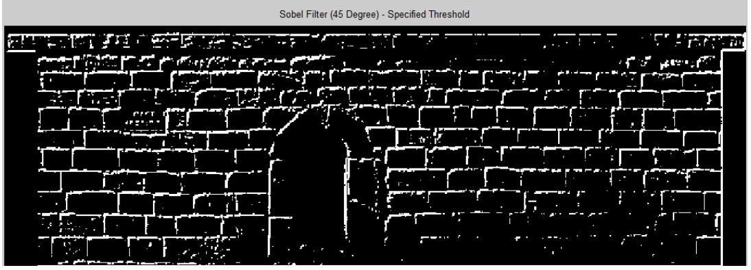
Şekil 4.31 : Sobel kenar belirleme operatöründe 45 derece yön ve 150 eşik değeri sonucu oluşan görüntü.
