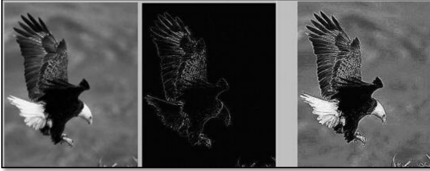
Şekil 2.23 : (a)Orijinal görüntü (b)Laplace maskesi geçirilmiş görüntü c) Maske ile görüntünün toplanmış hali.
