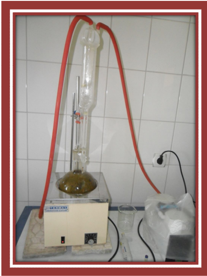
Şekil 3.17. (a) Biberiye uçucu yağının çıkarılmasında kullanılan clevenger düzeneği (b) Biberiye uçucu yağının saklandığı şişe
