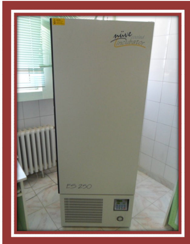
Şekil 3.20. Callosobruchus maculatus erginlerinin uyuşması için kullanılan soğutmalı inkübatör
