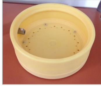
Şekil 7.13 Isıtıcı koruma haznesi
