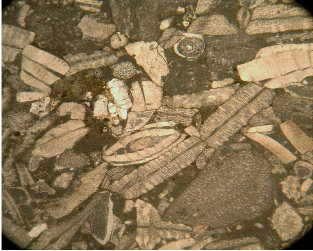
Şekil 3.13: Ayancık Kumtaşı Üyesi'nden alınan kalkarenit örneğinin mikroskop altında 4 defa büyütülmüş görüntüsü.
