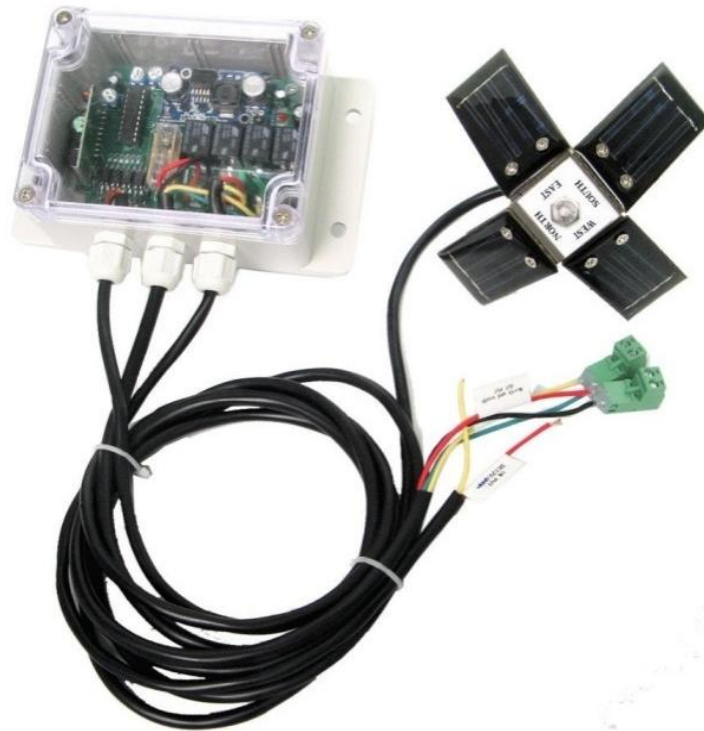
Şekil 2.29. Güneş takip sistemi
