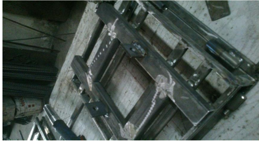
Şekil 2.12. Ortada güçlendirilmiş çerçeve, ana mil bağlantı noktası ve mil menteşeler
