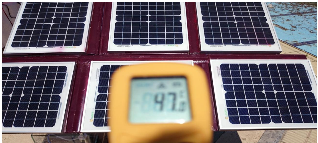
Şekil 3.20. Kızılötesi termometre ile panel yüzey sıcaklığının ölçülmesi
