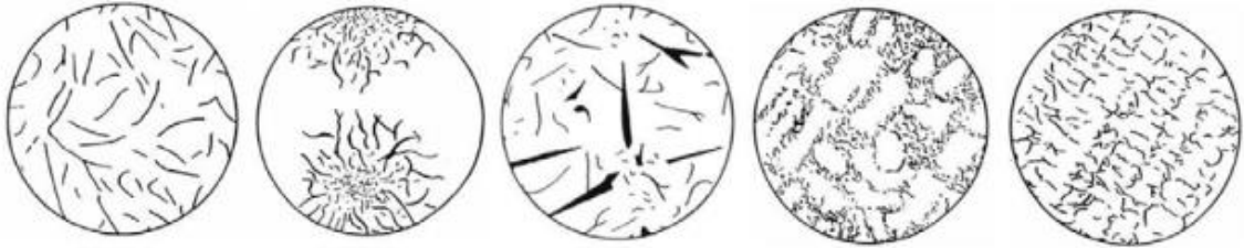
Şekil 2.1. Sırasıyla A-E tipi lamel grafitli dökme demir mikroyapısı (ISO_945-1)
