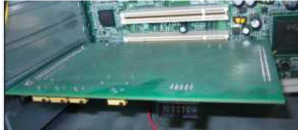
Şekil 3.1. Veri toplama kartının bilgisayar slotlarına yerleştirilmesi.
