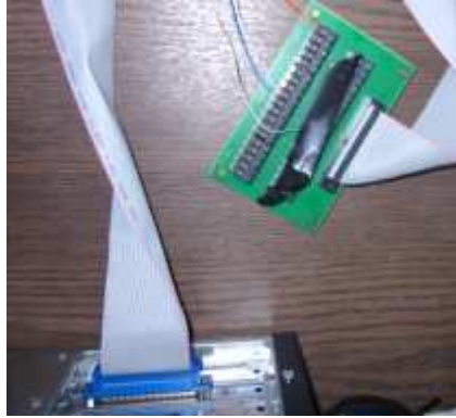
Şekil 3.2. Veri toplama kartı ile arayüz kart bağlantısı.
