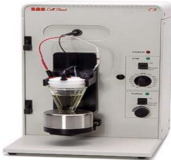
Şekil 3.2. Çalışmanın yapıldığı BAS C3 elektrot hücre standı
