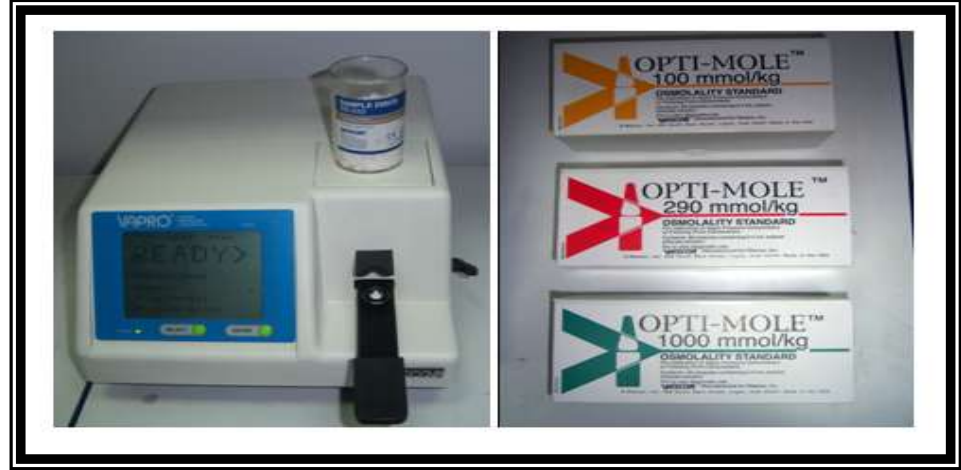
Şekil 3.2 Viescor marka Vapro (Vapor Pressure Osmometer) 5520 model osmometre cihazı ve standartları
