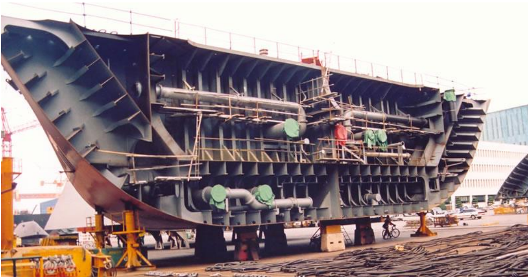
Şekil 2.3 : Gemiye oluşturan bloklardan birinin görünümü.
