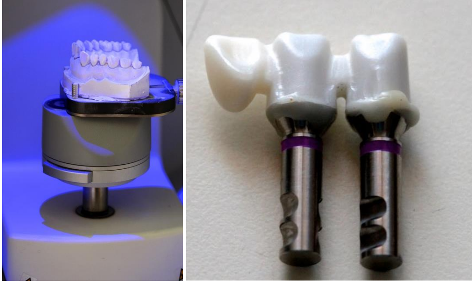
Resim 3.17. (A) Modele vidalanan dayanaklar zirkonya restorasyonun üretilmesi için taranması, (B) Üretilen restorasyon, analoglara vidalanan dayanaklara geçici olarak simante edilmesi
