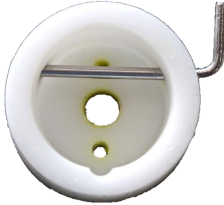
Resim 3.18. Çiğneme simülatörüne örneklerin yerleştirilebilmesi için kullanılan poliüretan kalıplar
