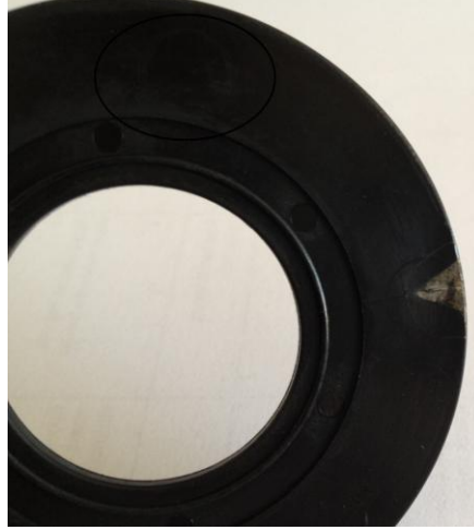
Şekil 7.9 Parça yüzeyinde yuvarlak halkalar
