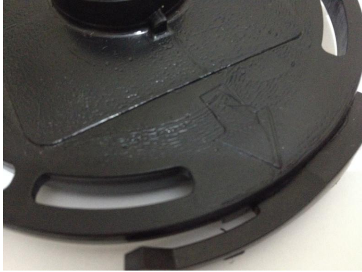
Şekil 7.16 Kalıp yüzeyinde farklı renkte dalgalanma
