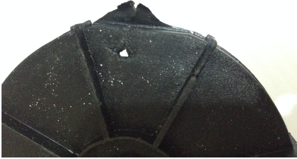
Şekil 7.18 Parça içinde boşluklar
