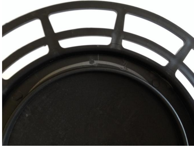
Şekil 7.14 Parçada gri gümüş renkte dalgalanma
