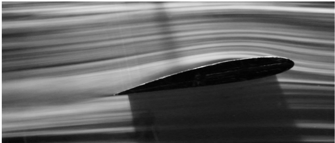
Şekil 2.11. AR 1,5 NACA 2415 profili 10^\circ hücum açısında duman görüntüleri, Re=50000 ( a)Perspektif çekim b) Uç kısmından çekim c) Uçtan x/c=0,1 kadar içerden çekim d) Orta kısımda çekim e) Orta kısımda çekim)
