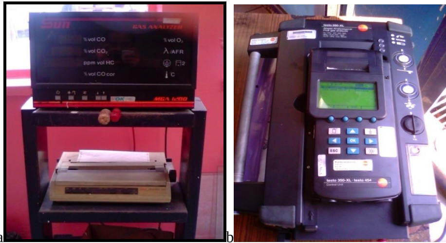
Şekil 3.4.a. MGA 1200 model emisyon analiz cihazı ve b. Testo 350-XL Flue Gas Analyzer cihazı
