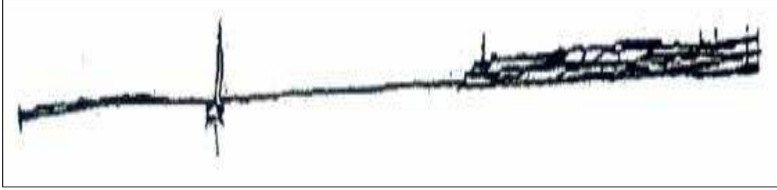
Şekil 4.3. Pürüzlülük sınıfı 0 olan arazi örneği ( Z_0=0,0002 m) [27]
