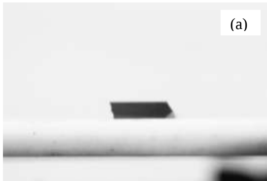
Şekil 4.36 Silisyum taban malzeme üzerinde büyüyen KNT'lerin çekilen fotoğrafları
