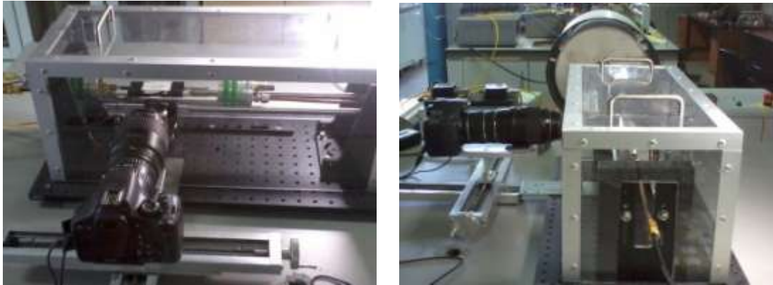
Şekil 4.35 Makro çekim yöntemi ile fotoğraf çekimi için tasarlanan deney sistemi
