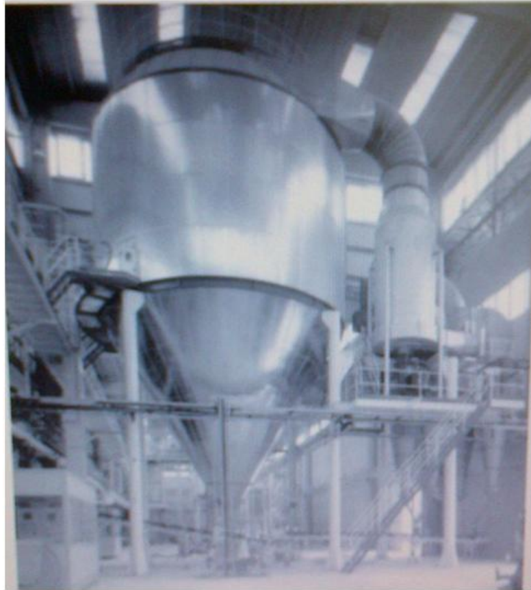
Şekil 2.12: Spray Drier (Püskürtmeli Kurutucu).
