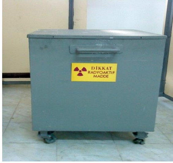
Şekil 3.23. Ölçümlerde kullanılan nötron kaynağı (Parafin ve kurşun koruma içinde)
