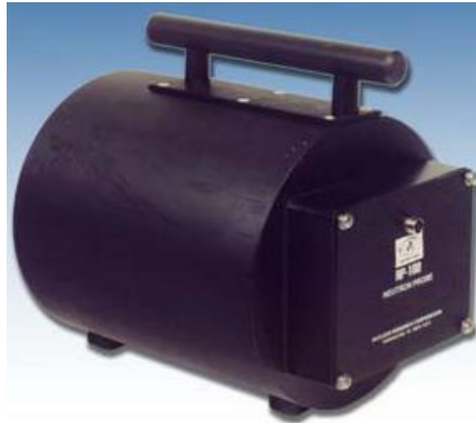
Şekil 3.24. Deneyde kullanılan Canberra NP100B nötron dedektörü
