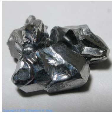
Şekil 3.5. Kromun görünümü ve kristal yapısı (Anonymous 2014i)
