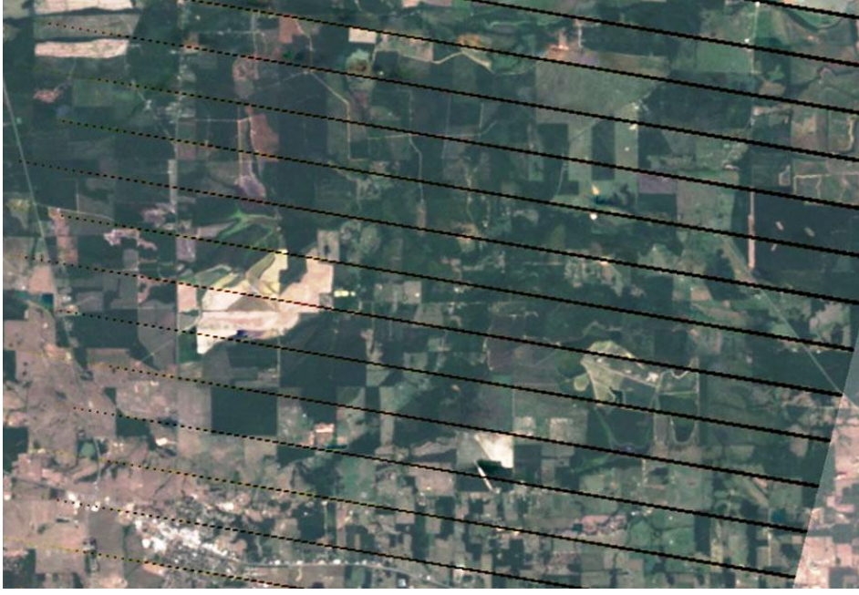
Şekil 4.13 : LANDSAT-MSS algılayıcısındaki şerit hataları [30].
