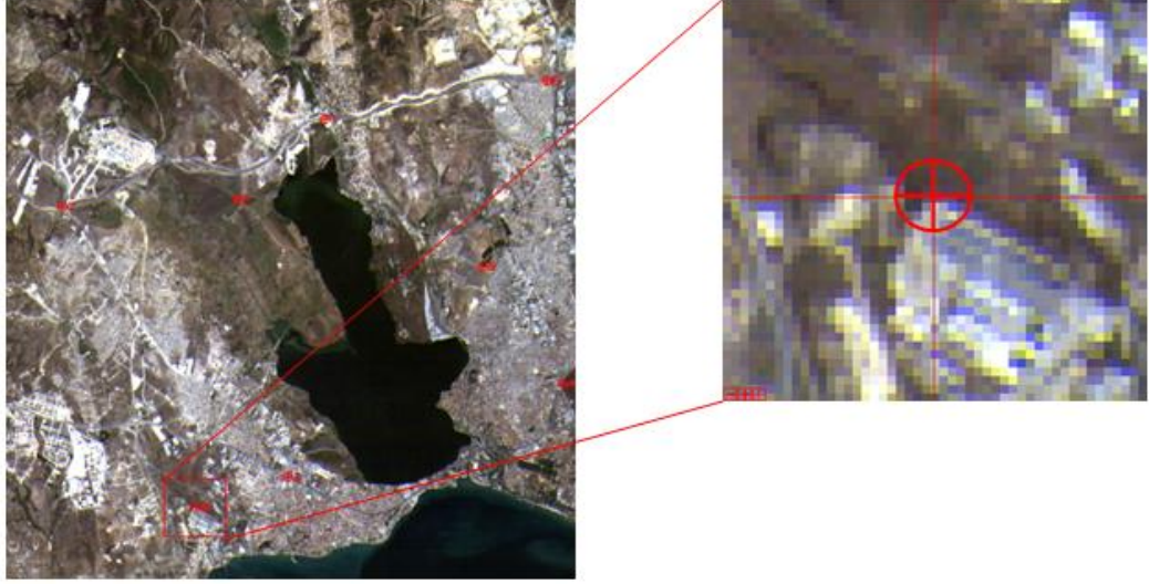
Şekil 4.14 : Yer kontrol noktalarının seçimi.
