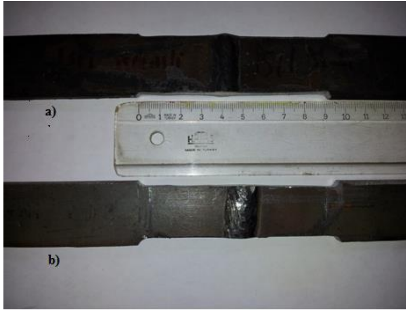
Şekil 5.35 : Kaynak sonrası a) ısıtım işlem uygulanmış ve b) ısıtım işlem uygulanmamış çekme testi numuneleri.
