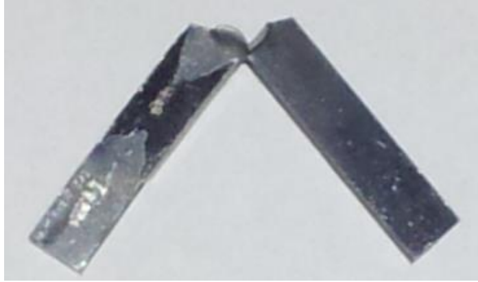
Şekil 5.34 : Kaynaklı ve ısıtılmış işlem görmüş zırh çeliğinin tokluk ölçümü sonrası kırılma noktası.
