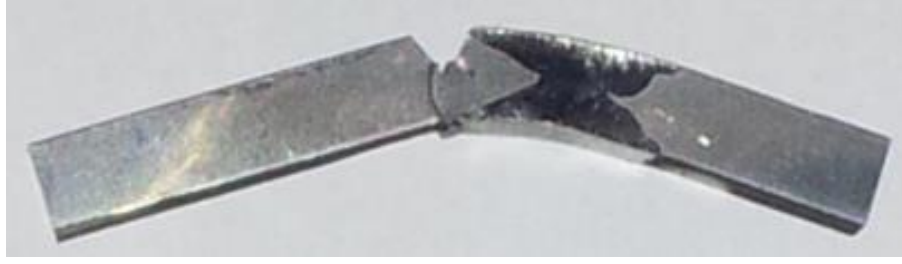
Şekil 5.33 : Kaynaklı ve ısıtılmış işlem görmemiş zırh çeliğinin tokluk ölçümü sonrası kırılma noktası.
