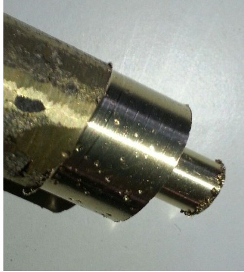
Şekil 3.41 Ham CuSn10' un içerisindeki gözenekler
