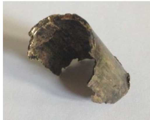
Şekil 3.35 Kalıpların arasına dolan CuSn10
