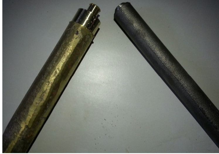
Şekil 3.29 Talaşların elde edildiği döküm çubukla
