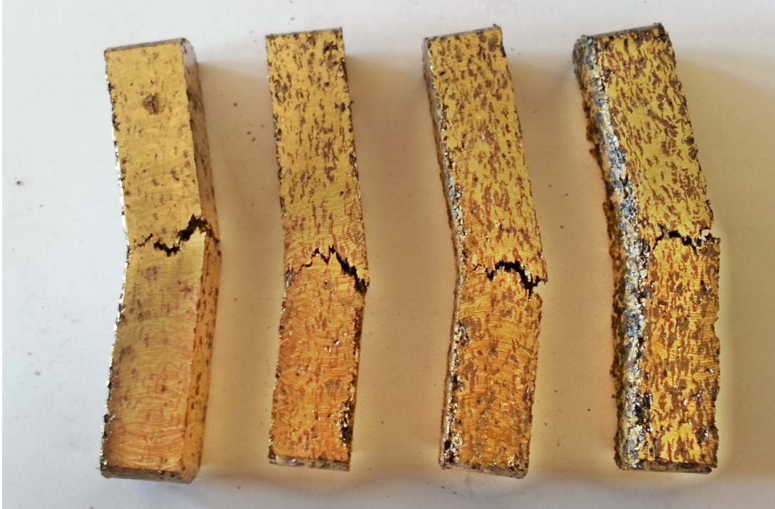
Şekil 4.19 820MPa-400° C de üretilen numunelerde çatlak ilerlemesi
