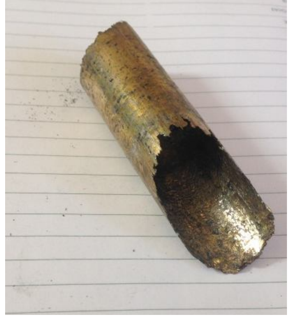
Şekil 3.34 Bronzun dişi ve erkek kalıp arasına dolması
