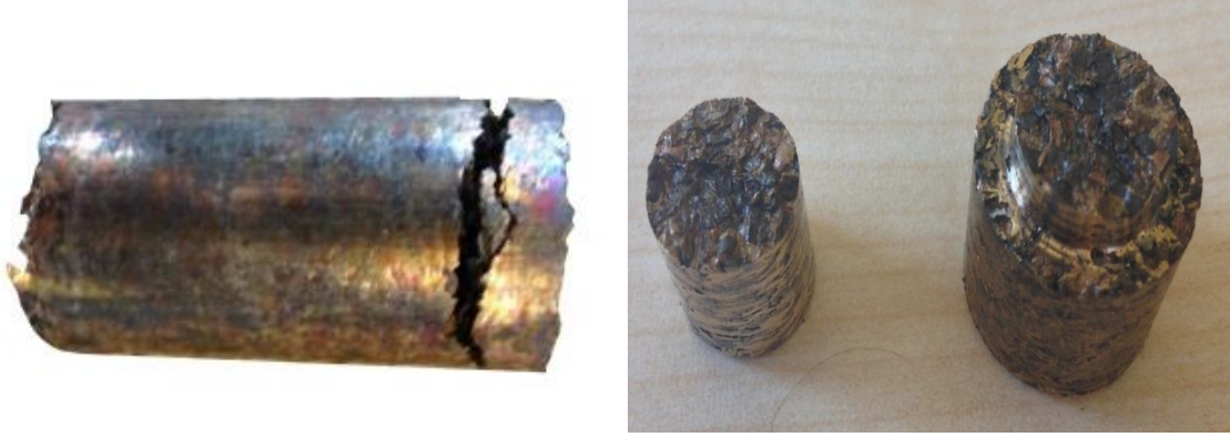
Şekil 3.28 Etkili bir birleşim sağlanamayan ön deneme numuneleri
