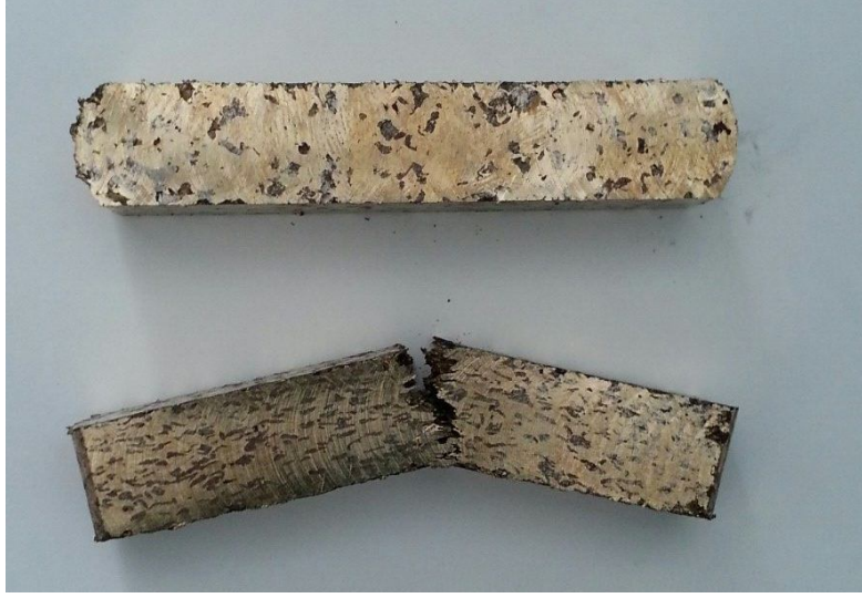
Şekil 3.56 Ham numune ve kırık numune görüntüsü
