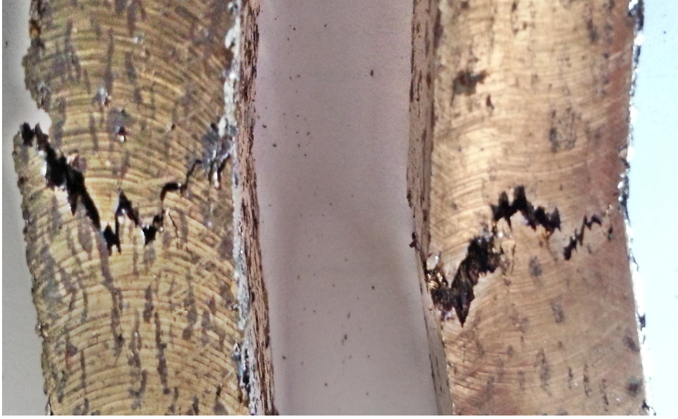
Şekil 4.20 820MPa-400 °C de üretilen numunedeki çatlak ilerlemesi
