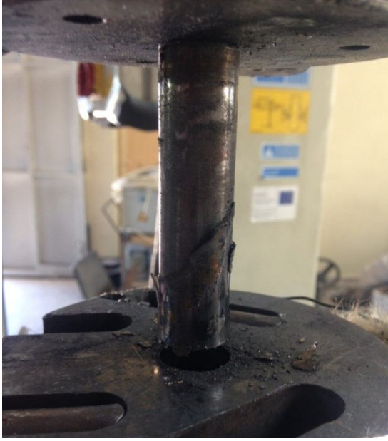
Şekil 3.34 Bronzun dişi ve erkek kalıp arasına dolması
