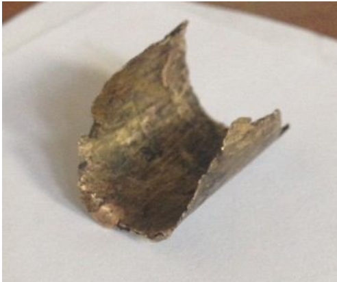
Şekil 3.35 Kalıpların arasına dolan CuSn10
