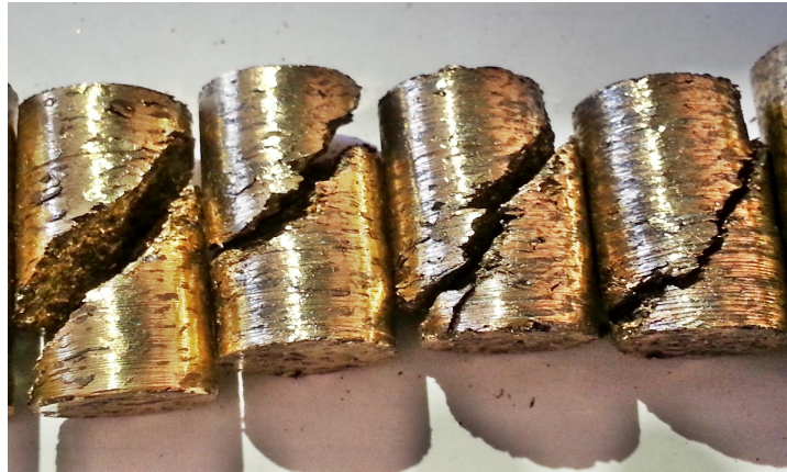
Şekil 4.9 820MPa ve 400^\circ\text{C} de üretilen numunelerin ( %90-80-70-60 CuSn10) kırılma şekilleri
