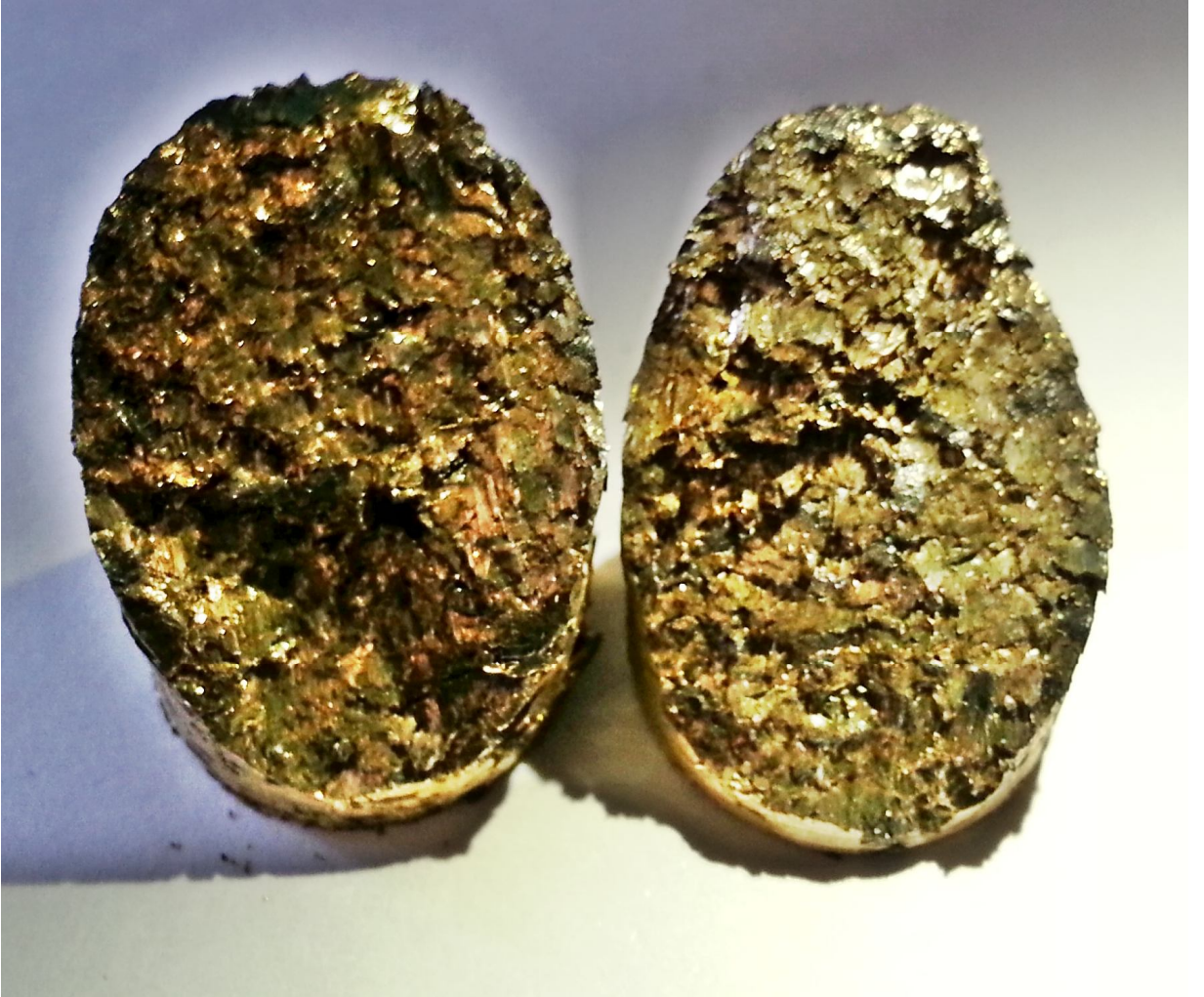
Şekil 4.11 820MPa ve 400°C de üretilen 90B10D numune kırık yüzeyi
