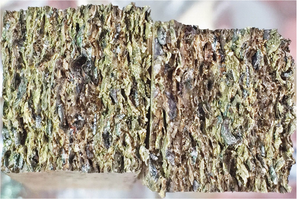
Şekil 4.21 Prizmatik numune kırık yüzeyi
