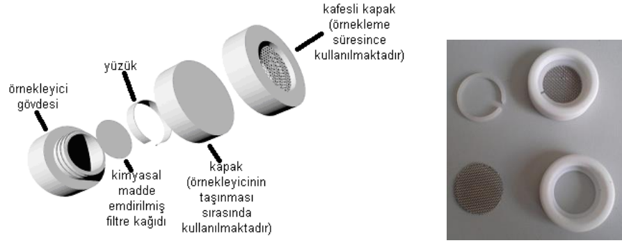
Şekil 3.9 Plastik pasif örnekleyici ve parçaları (Özden ve ark. 2008)
