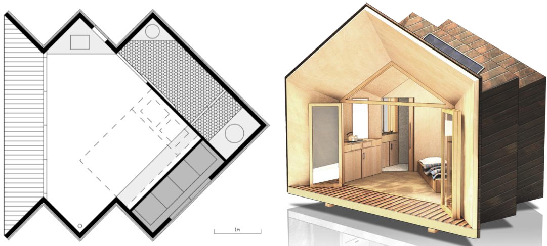
Şekil 4.36. Hermit House Projesi, kullanıcıya yönelik konstrüksiyon elemanları kiti ve yapım kılavuzu.
