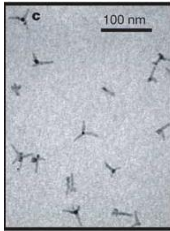
Şekil 2.4. a) ve b) Alivizatos ve arkadaşları tarafından sentezlenen bazı tetrapod şekilli CdSe nanokristallerine ait TEM görüntüleri (Milliron ve ark., 2004).
