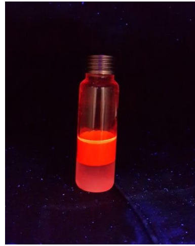
Şekil 3.9. CdTeSe nanokristallerinin DDT ile gerçekleştirilen ligand değişim prosesi; CdTeSe nanokristallerinin deiyonize su ile hazırlanmış çözeltisinin a) gün ışığı ve b) UV lamba altındaki, CdTeSe nanokristallerinin üzerine DDT-aseton karışımı ilavesinden sonraki çözelti karışımının c) gün ışığı ve d) UV lamba altındaki, ligand değişim işleminden sonra üst faza geçmiş CdTeSe nanokristallerine ait e) gün ışığı ve f) UV lamba altındaki görüntüleri.
