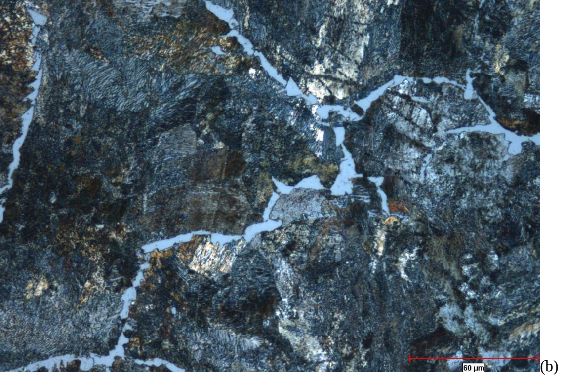
Şekil 6.5: (-5°C)'de Kaynaklanmış Rayın Kaynak Bölgesinin Mikroyapı Fotoğrafları: a) 100x, b) 500x
