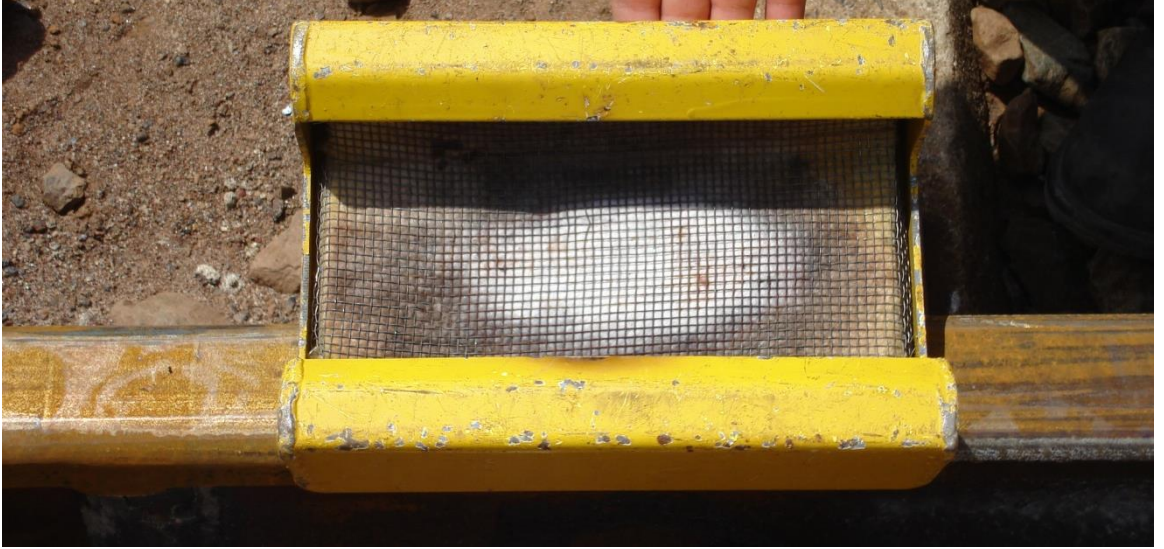
Şekil 4.3: Kaynak Koruma Tüneli (Kaçer, 2008 a)
