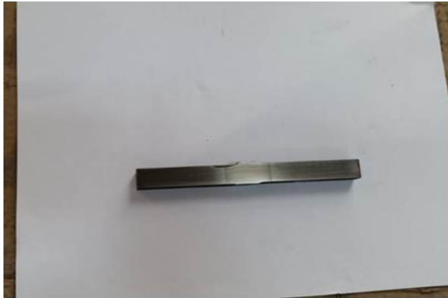
Şekil 6.12: Ray Tabanına Yapılan Makro Muayene Fotoğrafi
