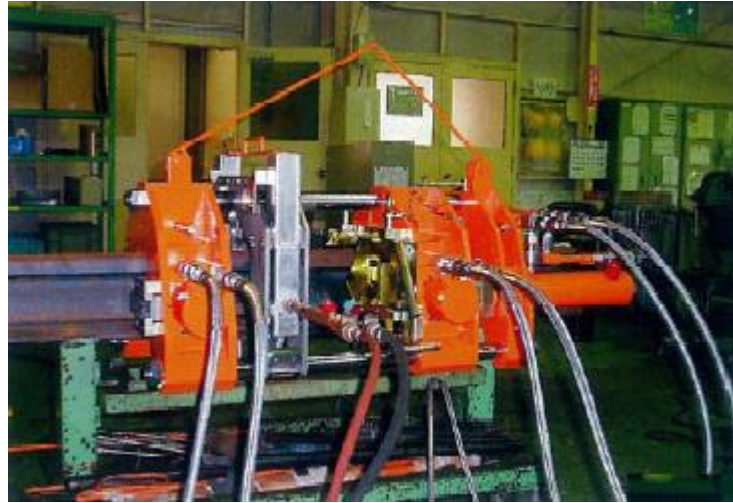
Şekil 4.28: Gaz Basınç Kaynağı Makinasının Kurulması
