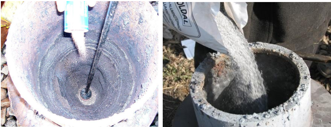
Şekil 4.20-a) Manyezit tozunun dökülmesi, b) Termit porsiyonunun dökülmesi
