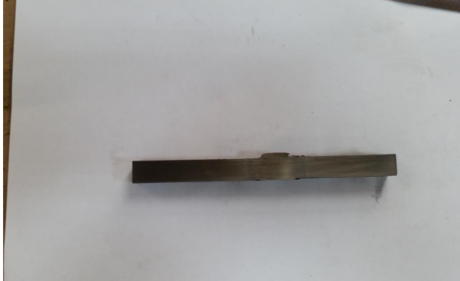
Şekil 6.19: (51°C)'de Kaynaklanmış Rayın Tabanına Uygulanan Makro Muayene İncelemesine Ait Fotoğraf
