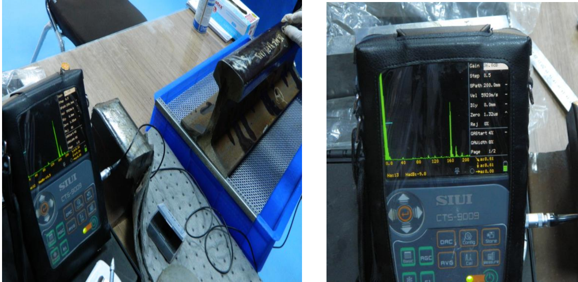
Şekil 6.10: (-5°C)'de Kaynaklanmış Raya Uygulanan Ultrasonik Muayene Testi
