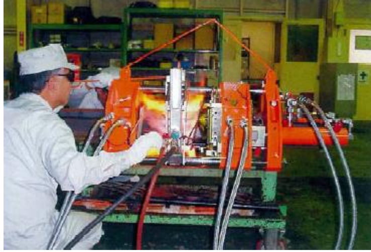
Şekil 4.29: Gaz Basınç Kaynağı uygulanma anı
