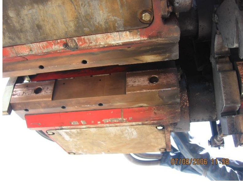
Şekil 4.10: Kaynak makinasında bulunan bakır elektrotlar
