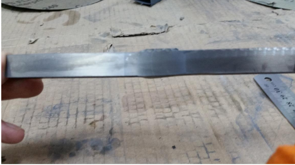
Şekil 6.2: (-5°C)'de Kaynaklanmış Rayın Tabanına Uygulanan Makro Muayene İncelemesine Ait Fotoğraf
