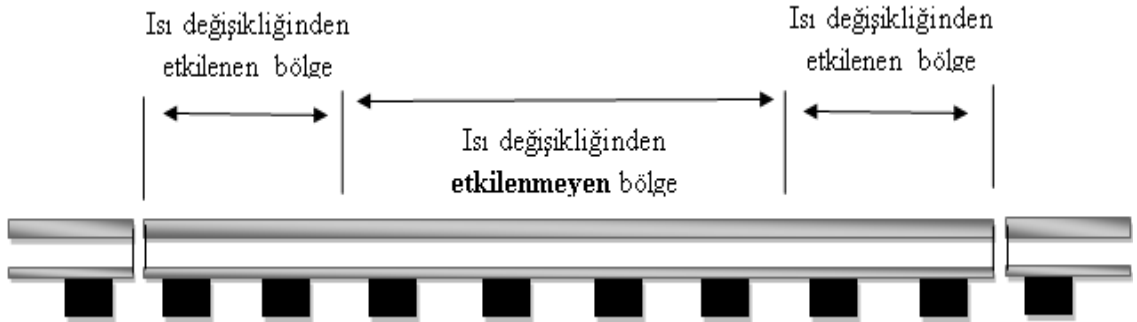
Şekil 4.2: UKR yollarda ısı değişimlerinin etkilediği bölgeler
