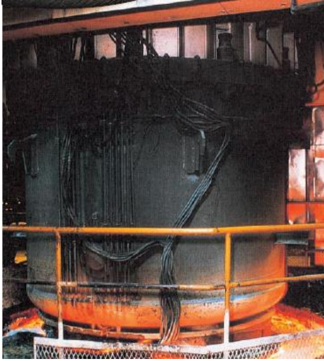
Şekil 3.4: Vakumla gaz giderme ve argon üfleme potası ve şematik gösterimi (JFE Steel Corporation, bt)
