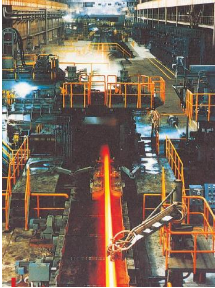
Şekil 3.6-a: Haddeme prosesi (JFE Steel Corporation, bt)
