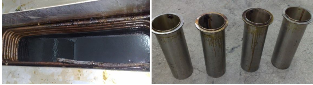
Şekil 4.4. Piroliz deney sistemi yoğunlaştırma birimi ve sıvı ürün toplama kapları
