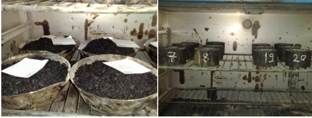
Şekil 4.68. Bitümlü sıcak karışım deney numunelerinin kısa ve uzun dönem yaşlandırılması
