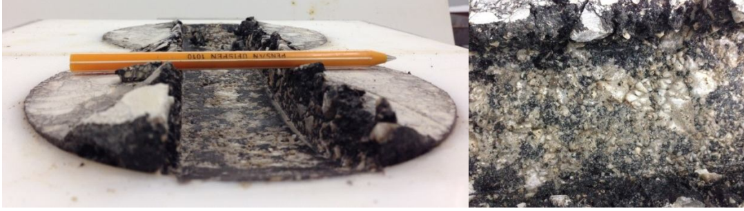
Şekil 4.89. Numunelerde oluşan tekerlek izi derinliği ve meydana gelen su hasarı
