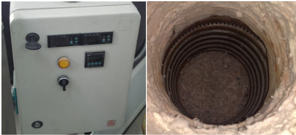
Şekil 4.3. Piroliz deney sistemi PID sıcaklık kontrol birimi ve direnç telleri
